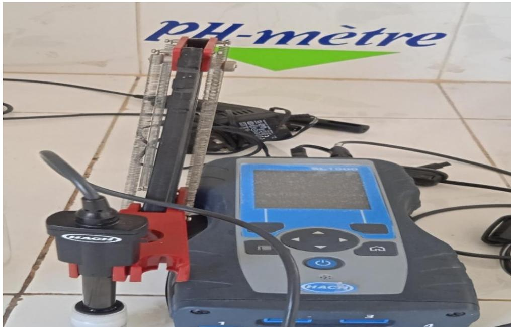
**Photo 1:** Multi-paramètre Portable HACH SL1000. (Station de Hammam Debagh)
