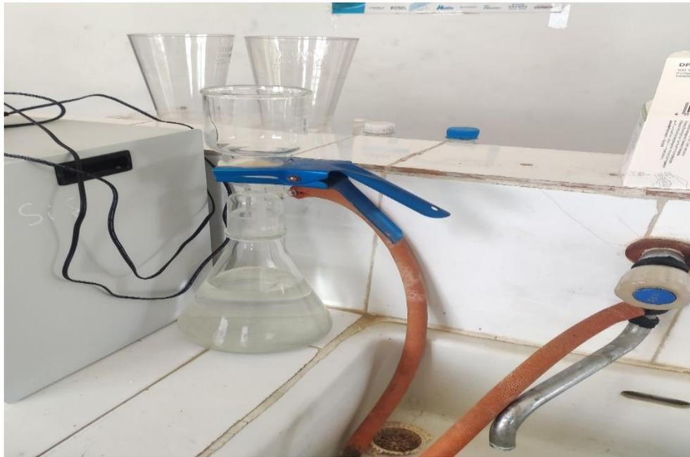
**Photo 4:** Un dispositif de filtration. (Station de Hammam Debagh)
