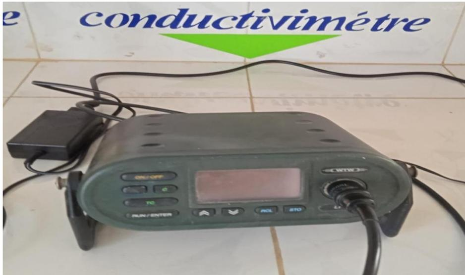
**Photo 2:** Conductimètre WTW LF197. (Station de Hammam Debagh).
