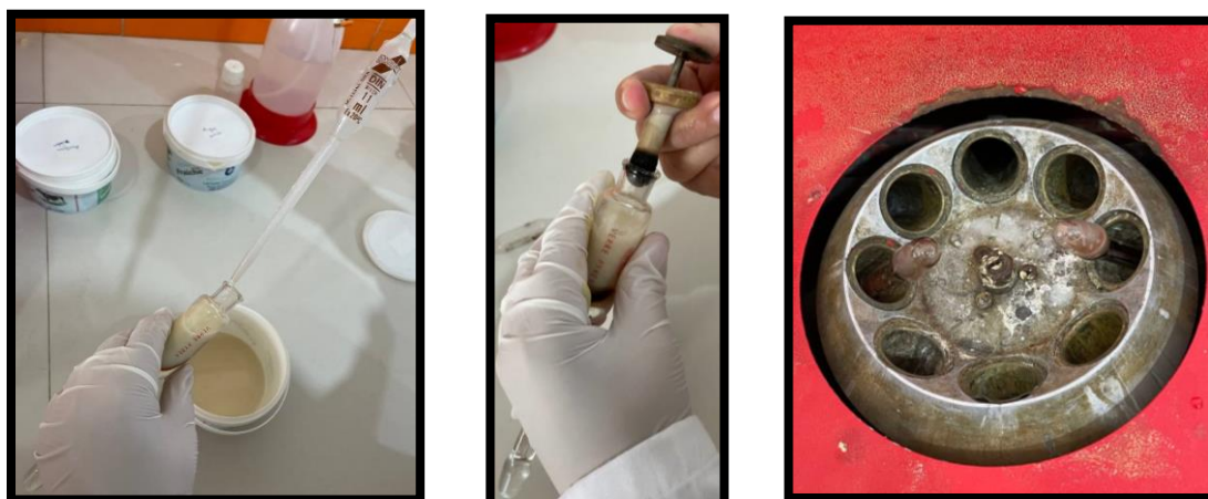
Figure 12 : Dosage de matière grasse par méthode de Gerber.
