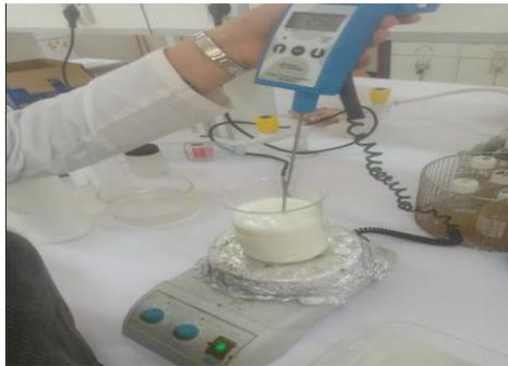
**Figure 10. Mesure de température de lait cru.**
