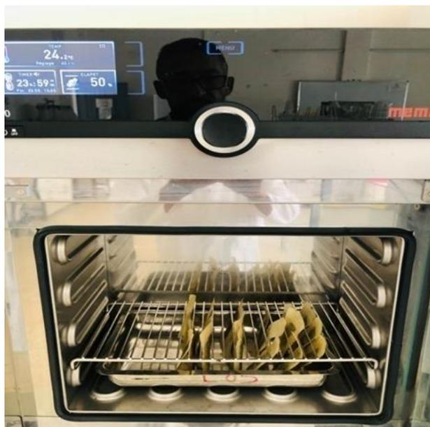
**Figure 13 :** Mise au séchage des sacs de digestibilité
