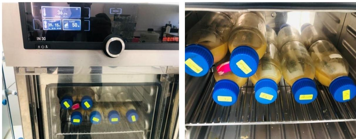
**Figure 11 :** Incubation des échantillons pour mesurer de la digestibilité de la matière sèche
