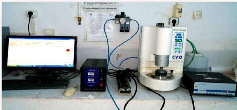
Figure III. 11. Rhéomètre Dynamic Bohlin CVO-100-901 de Malvern.
