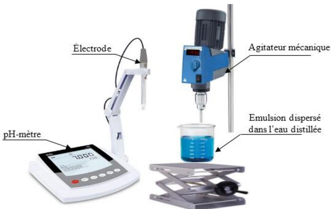
**Figure III.12.** Montage expérimental pour l'étude de la stabilité du MLE.
