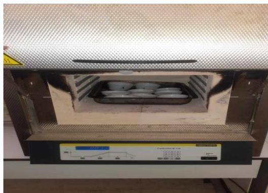
**Figure 13:** Les échantillons dans le four à 500°C(Photographie par Bouneb et Djaaleb le 26/02/2024 a 9 :30 h).
