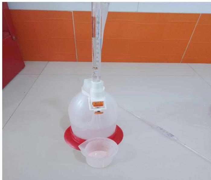
**Figure 8 : Détermination de l'acidité**
