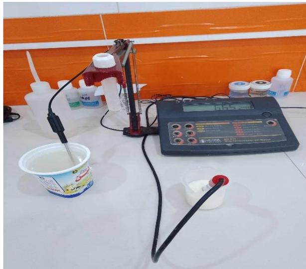
**Figure 6 : Détermination du pH avec pH-mètre**
