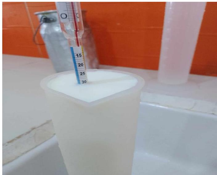
**Figure 7 : Détermination de la densité**
