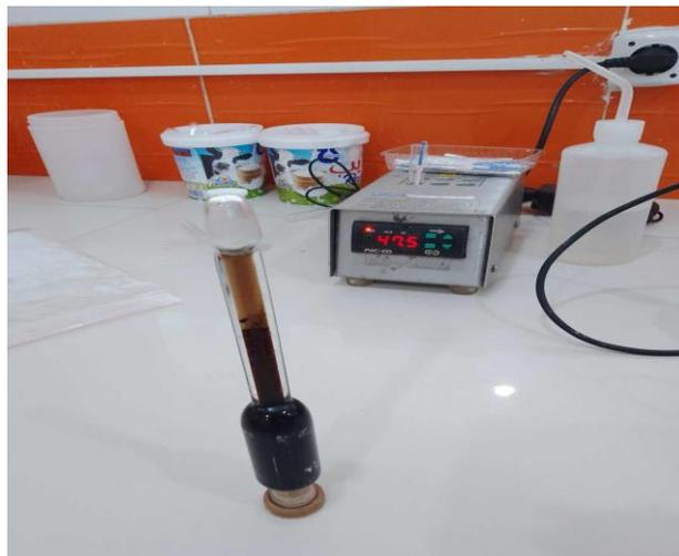
**Figure 10 : l'échantillon sur le butyromètre**
