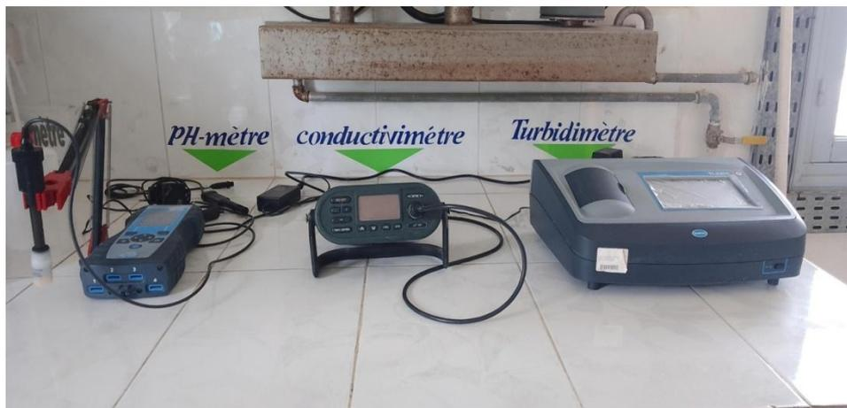
**Figure 30:** les Appareils de mesure des paramètres physiques.(Abadlia,2024)
