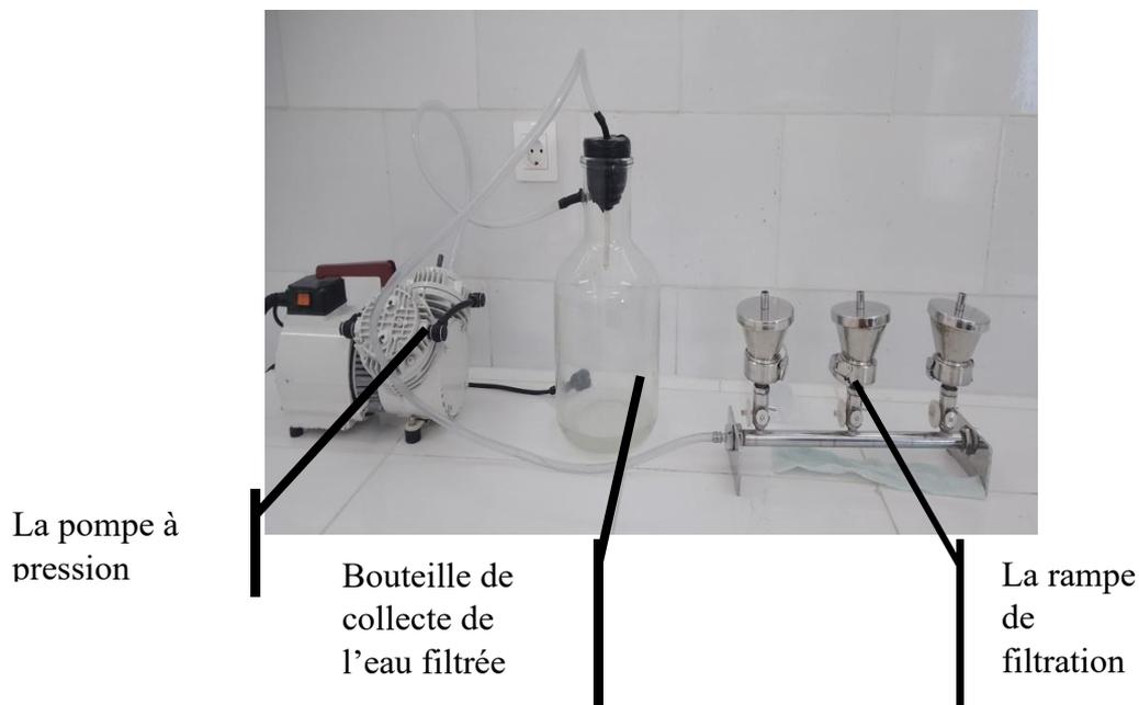
**Figure 12:** La rampe de filtration et ses extensions utilisées dans la méthode de filtration (Abadlia,2024)
