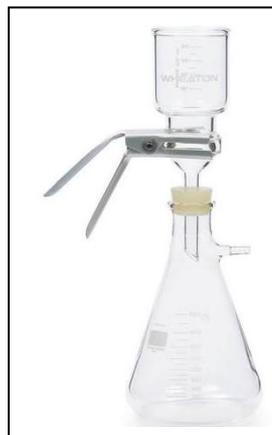
Figure 37: rampe de filtration sous vide(Abadlia,2024)
