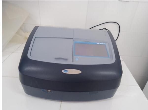
**Figure 39:** Spectrophotomètre (Abadlia,2024)
