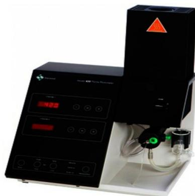
**Figure.25.** Photomètre à flamme.
