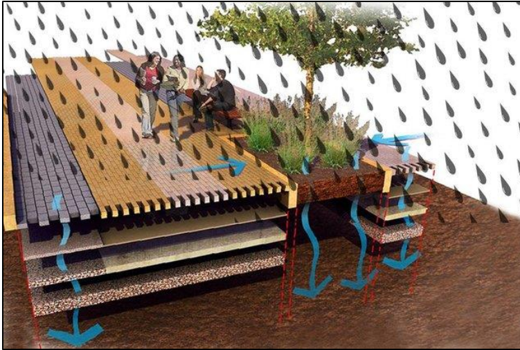
Figure II-17 : Section montrant comment le pavage et le paysage perméables collectent l'eau de pluie et diffusent les eaux pluviales (Kipkirui & Kageche, 2020).
