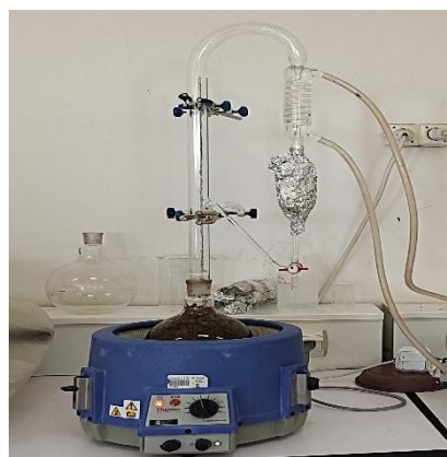
Extraction d'huiles essentielles de TC (A) et LS (B) par l'appareil de clevenger
