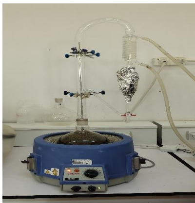
Extraction d'huiles essentielles de TC (A) et LS (B) par l'appareil de clevenger
