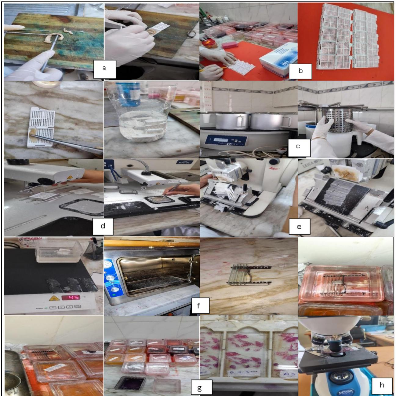
**Figure 15 :** Prélèvement des zones anormales et saines (a), emplacement des coupes dans des cassettes numérotées (b), déshydratation des coupes (c), inclusion dans la paraffine (d), réalisation des différentes étapes de la coupe (e), appareil de coloration (f), étiquetage et montage des lames (g), visualisation des lames sous microscope optique (h).
