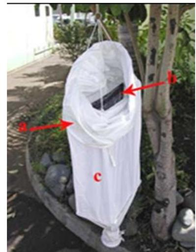
Figure 16 : Dispositif de Winkler : a : système de fermeture ; b : filet contenant la litière à traiter; c : corps du Winkler (Antoine Frank 2008)
