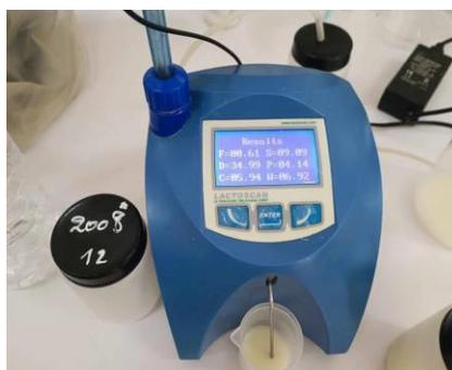
**Figure 29.** Lactoscan de type (ULTRASONIC MILK ANALYZER®) pour les analyses physicochimique du lait (Photo personnelle, 2024).
