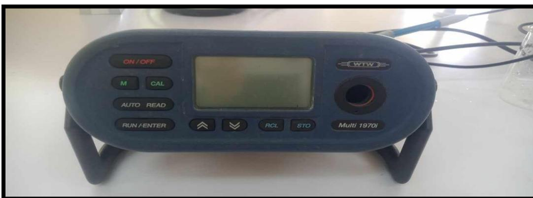
**Figure 8:** Multi paramètre WTW (Multi 1970i).
