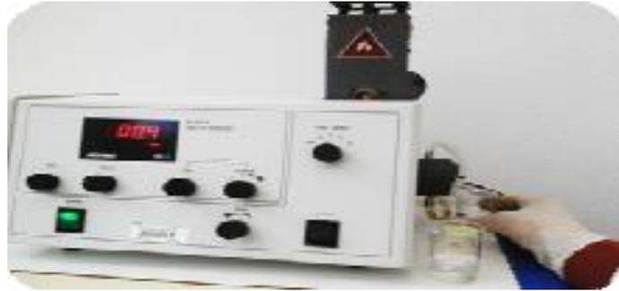
Figure 15 : Photomètre à flamme PFP
