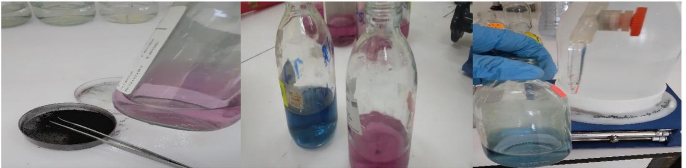
Figure 11 : les étapes d'analyse de TH sur l'eau
