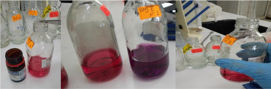
Figure 14 : les étapes d'analyse de calcium sur l'eau
