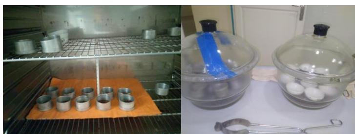
**Figure 11** : Détermination de la matière sèche.
