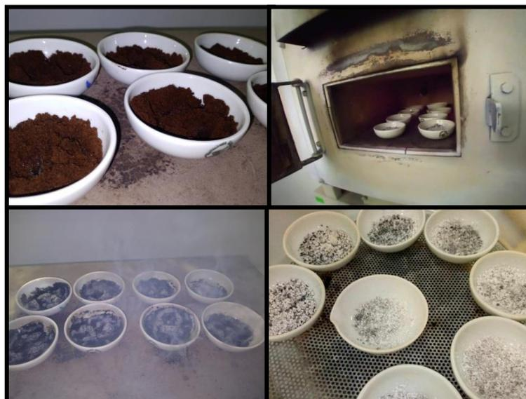
**Figure 12** : Détermination de la matière minérale. (Photo prise par Benouhidene).
