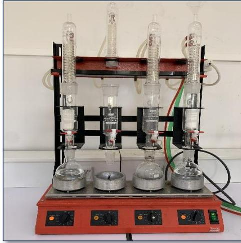
**Figure 21** : Appareil soxhlet d'extraction de la matière grasse (Benhamla et Krichiem, 2024).
