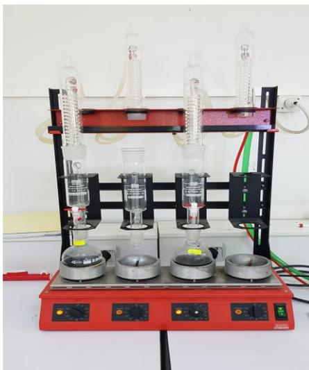
Figure 2.11. Montage de l'appareil de distillation (Soxlet)
