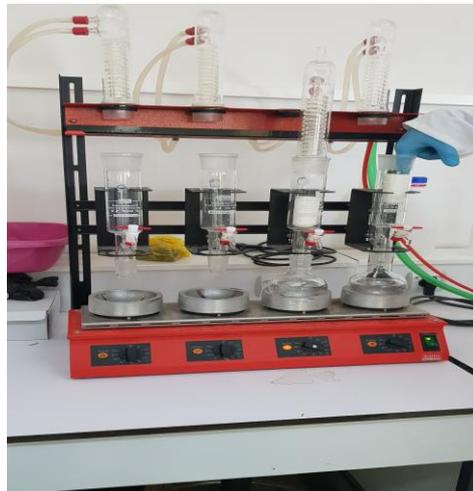
Figure 2.13 Montage de l'appareil de Soxhlet pour l'extraction des lipides.
