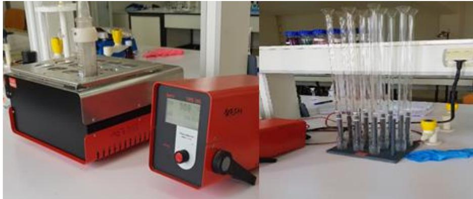
Figure 2.10. Montage de l'appareil de Kjeldahl.
