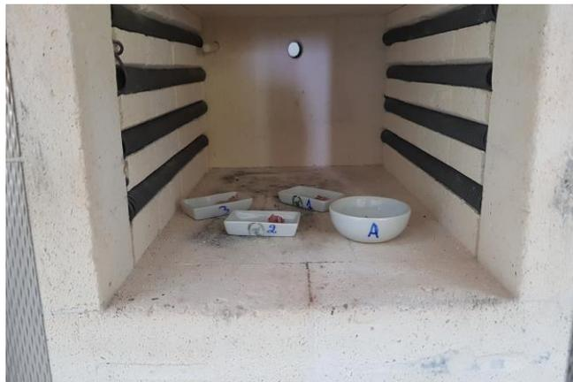
Figure 2.9. Les échantillons dans le Four à moufle (Type Nabertherm L5/11).
