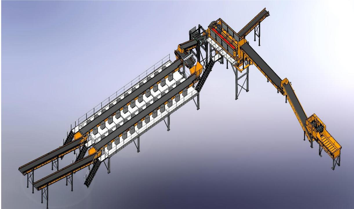
Figure 5.10 Rendu 3D du centre de tri des déchets réalisé avec SolidWorks
