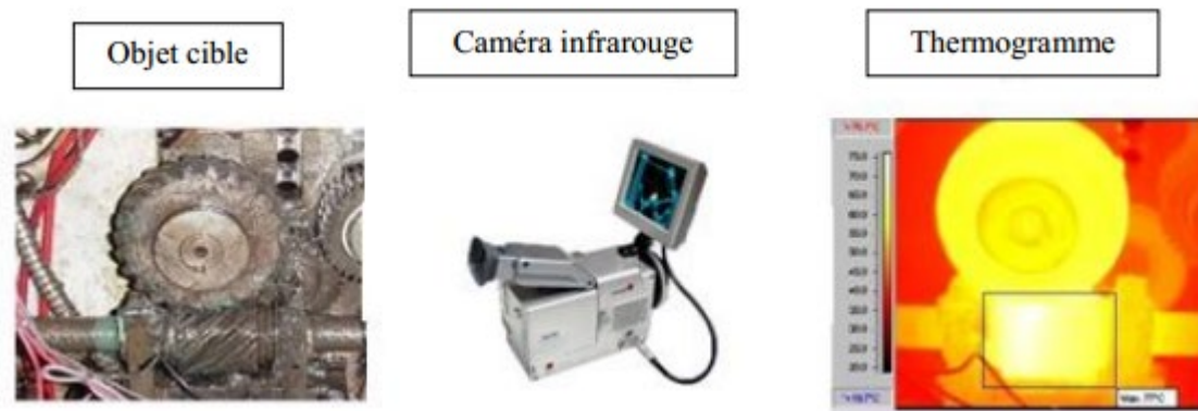
Figure I.4: Exemple de la thermographie infrarouge
