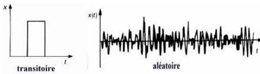
Figure II.7: Exemple d'un signal transitoire et un signal aléatoire
