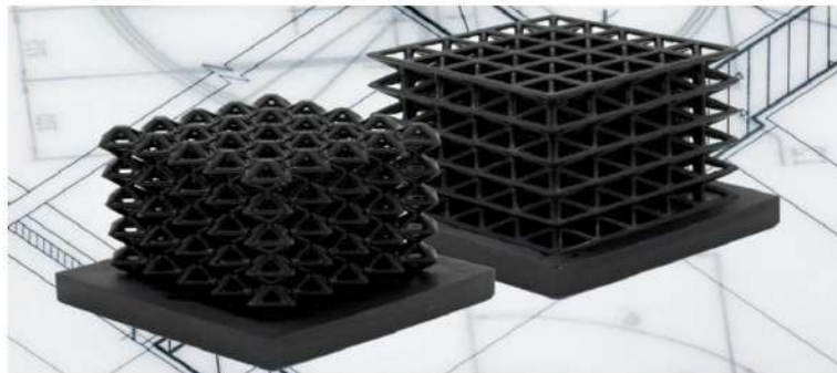
Figure 1.5 : Exemple d'un Treillis [12].
