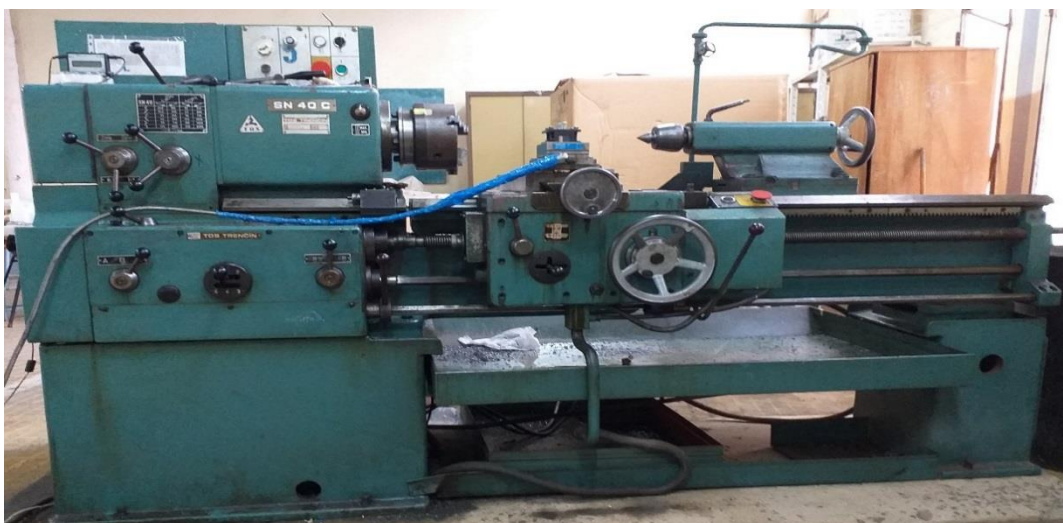
Figure III.1 : Tour à charioter et à fileter modèle SN40C.
