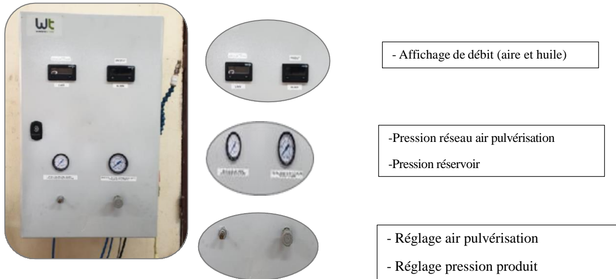
Figure II.10 boîte contrôle MQL
