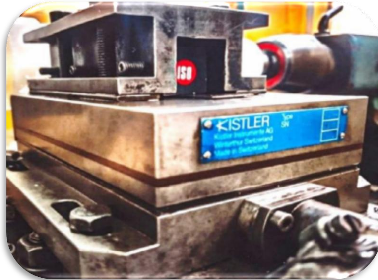
Figure II.6: Plate-forme KISTLER (modèle 9257 B).
