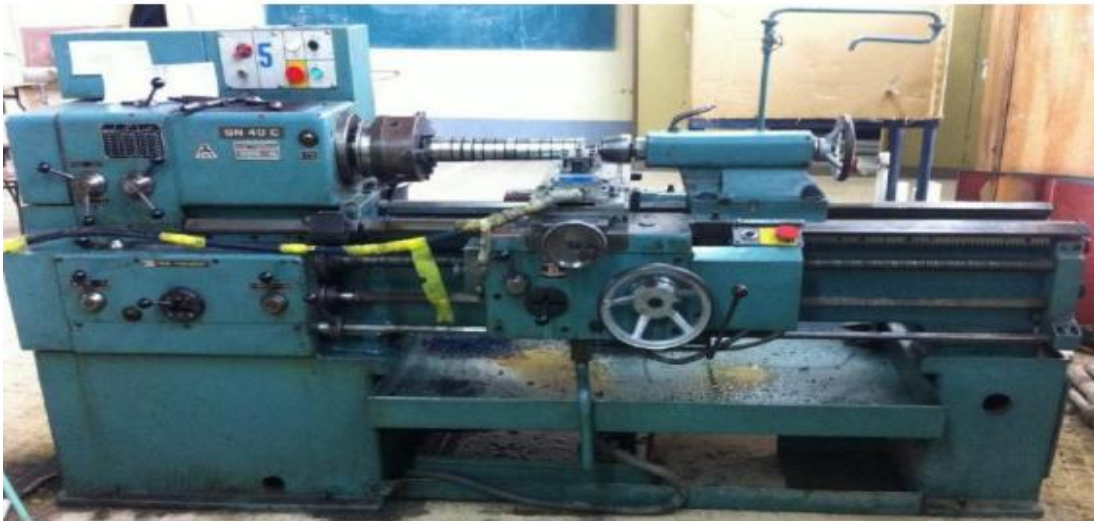
Figure II.1: tour à charioter et à fileter modèle SN 40.
