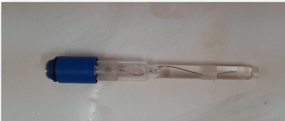
**Figure III.2:** électrode de référence Ag/AgCl utilisée dans la partie expérimentale.
