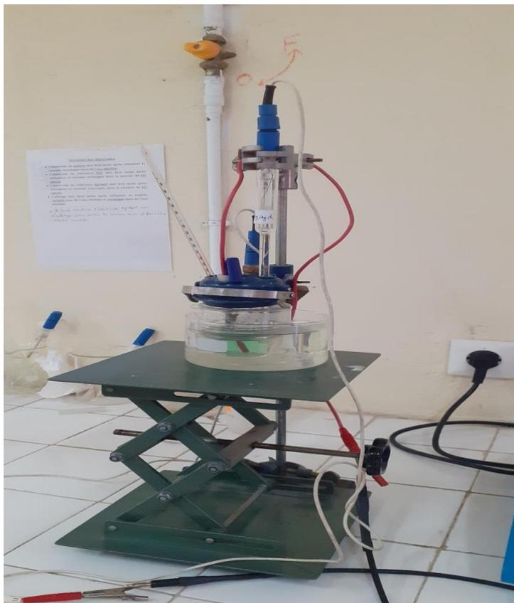
**Figure III.1:** Montage expérimental utilisé pour l'électrodéposition du nickel sur graphite.
