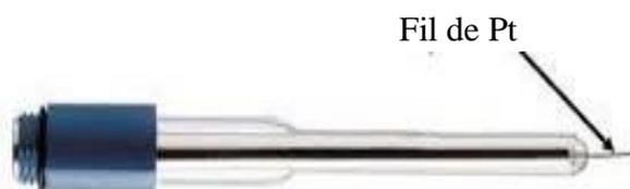
**Figure III.3:** Electrode auxiliaire en platine.
