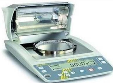
**Figure III.14 :** Dessiccateur utilisé au cours du contrôle.
