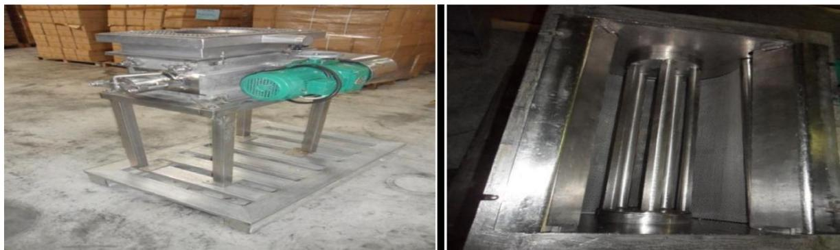
**Figure III.13 :** Calibreur oscillant FREWITT et Grilles d'ouverture de maille de 1,5mm.
