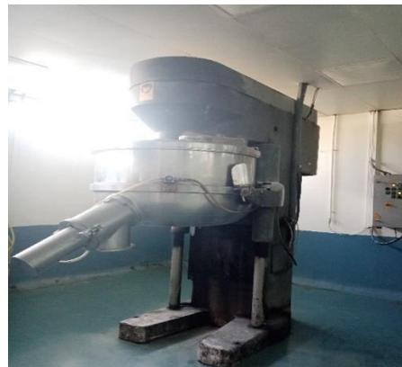
**Figure III.11** : Préparation du mélange à sec dans la Collette.
