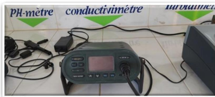
**Figure I.3:** Conductimètre.
