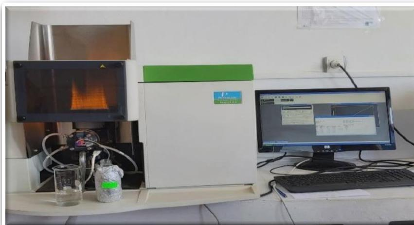
**Figure IV.4 :** Spectromètre d'absorption atomique.
