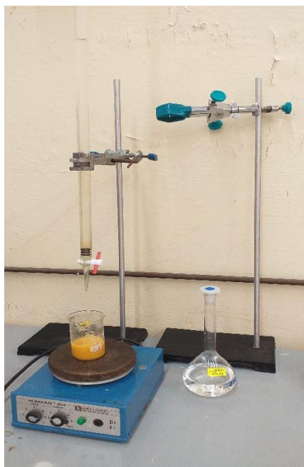
Figure III. 13 : Protocole expérimental de titrage
