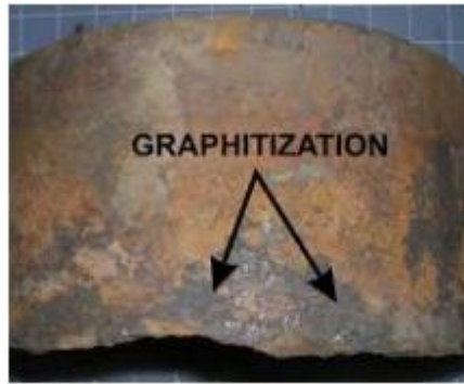
Figure I.6: Graphitisation d'une pièce en fonte.
