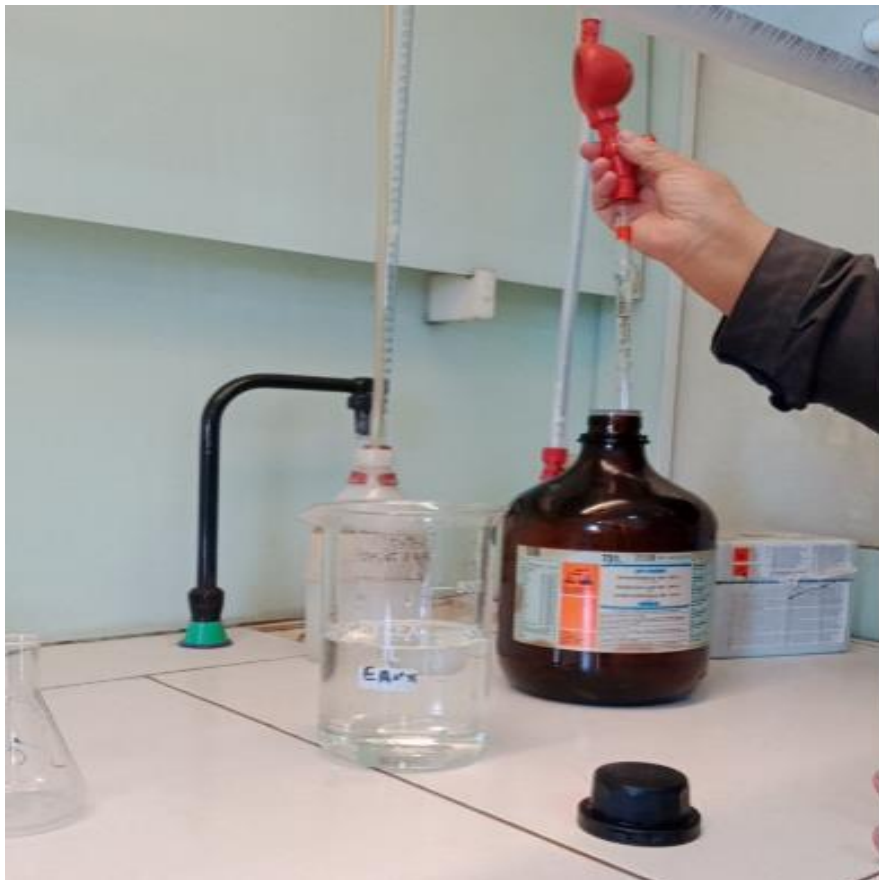
Figure III.2: Préparation de la solution corrosive 1M \text{H}_2\text{SO}_4
