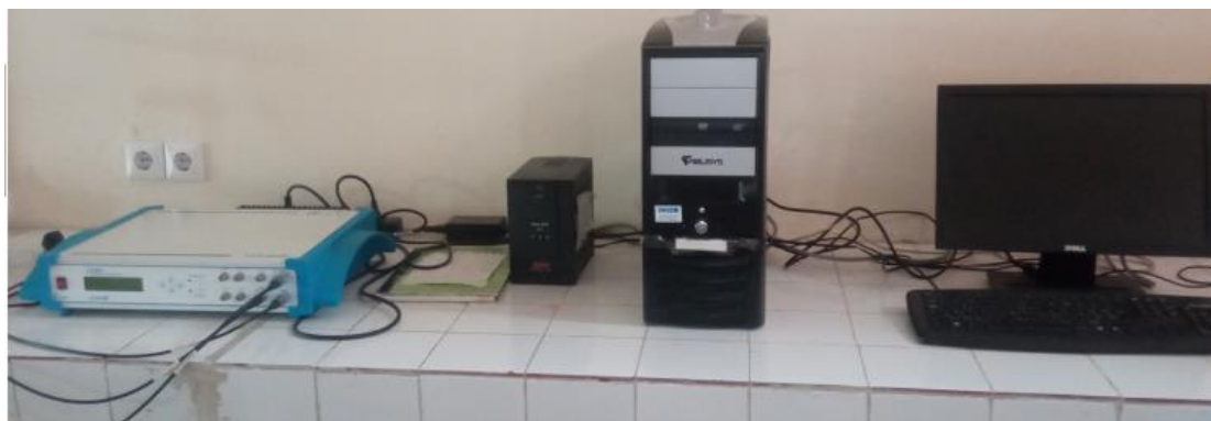
Figure III.15 : Potentiostat et ordinateur pour l'acquisition des données.
