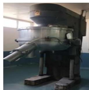
*Figure 2.7 : Mélangeur granulateur de type « COLETTE »*
