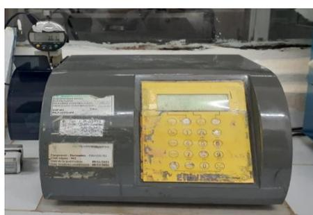
Figure 3.5 : Appareil Duromètre.
