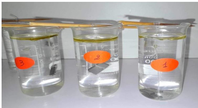
Figure IV.13: Schéma montrant l'essai de corrosion de l'aluminium dans la solution corrosive.
