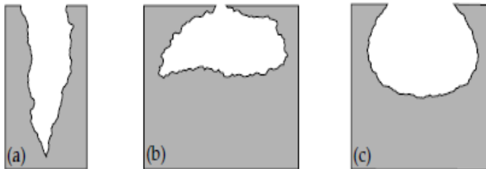
Figure I.5 : Formes de piqûres (a) cavité profonde (b) cavité cavernueuse (c) hémisphérique [2].
