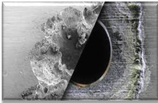
Figure I.7 : La corrosion de crevasse sur une connexion boulonnée [10].
