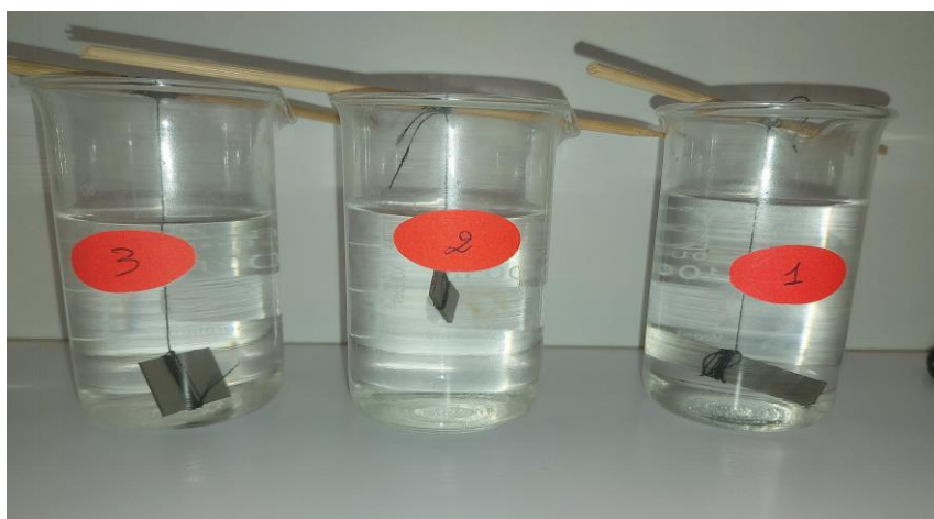
Figure IV.7: Schéma montrant l'essai de corrosion sur le titane.
