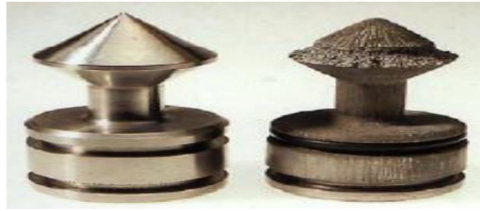
Figure I.9 : Corrosion-érosion due à de fortes vitesses de circulation du fluide corrosif [13].
