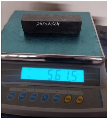
Figure II.22 : Mesure de la masse volumique à l'état sec.
