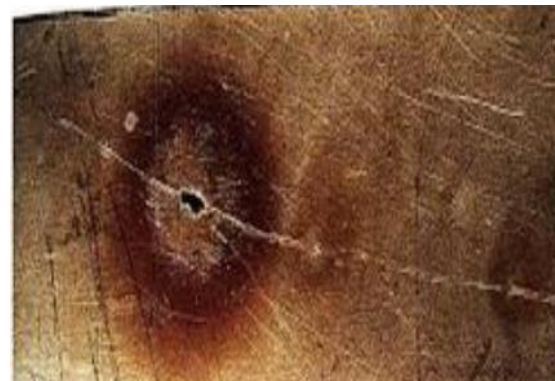
Figure I.4 : Corrosion par piqûres [8].
