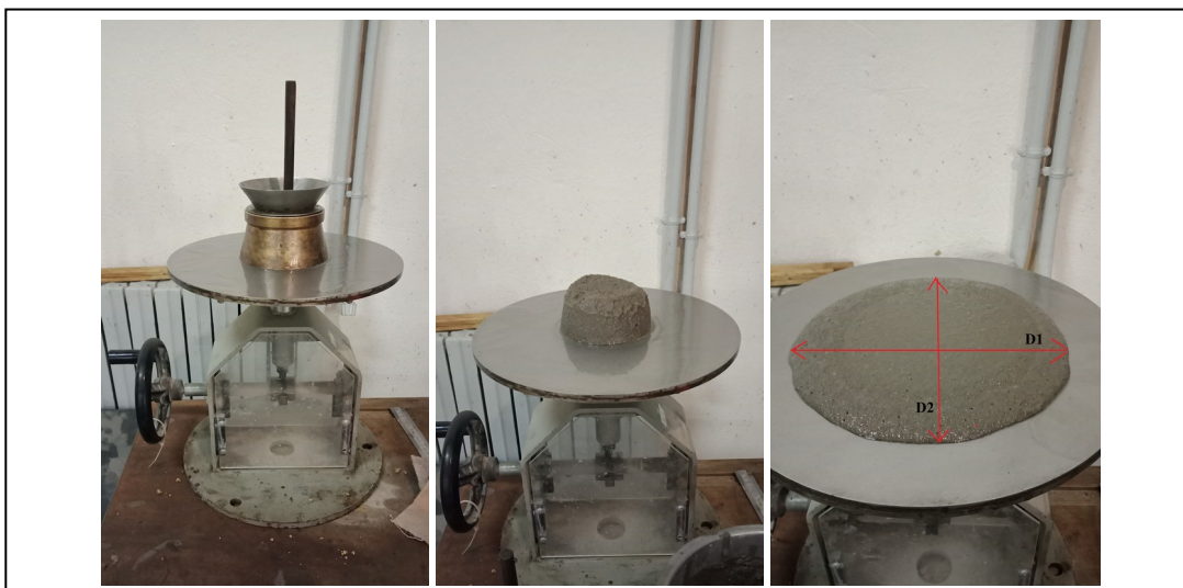
Figure II.21 : Essai d'étalement à la table à secousses
