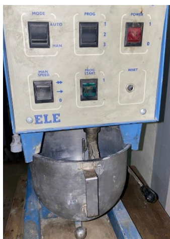
Figure II.20 : Malaxeur pour la préparation du mortier normalisé.
