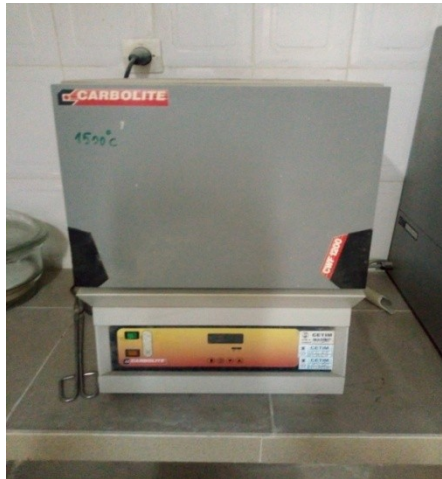
Figure II.14 : Four de calcination pour PAF.
