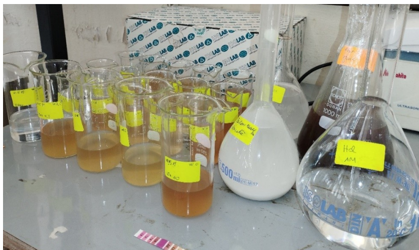
Figure II.6 : Milieux d'étude préparés : inhibiteur + SB + acide HCl.
