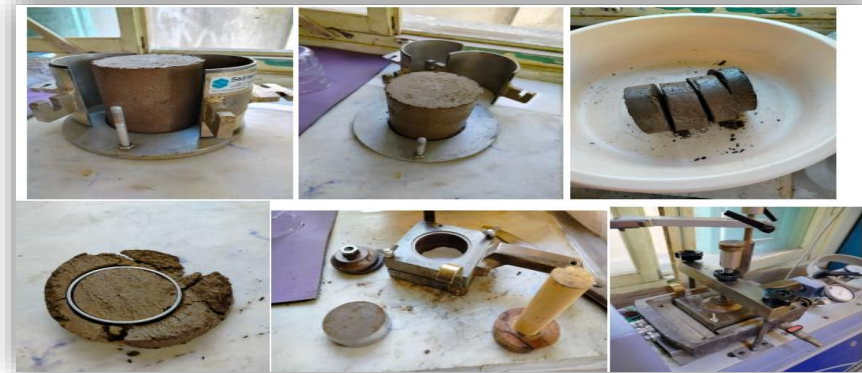
Figure III.21 Préparation de l'échantillon pour l'essai de cisaillement
