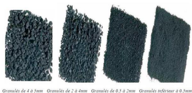
Figure II.13 Les différents diamètres de granulats des pneus usés après broyage [11]
