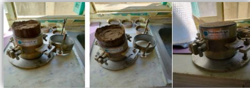
Figure III.18 Essai Proctor sur l'argile
