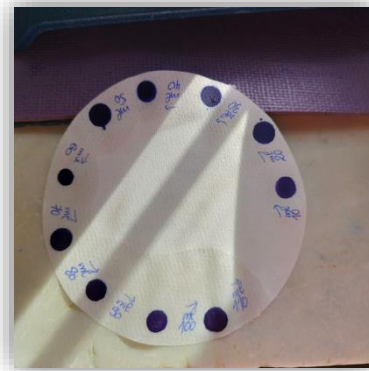
Figure III.8 Matériel d'essai au bleu de méthylène (résultats de l'essai à la tâche).
