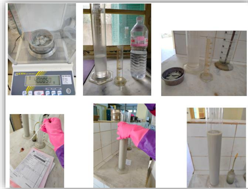
Figure III.3 Matériel d'essai de sédimentométrie
