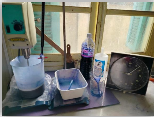
Figure III.8 Matériel d'essai au bleu de méthylène (résultats de l'essai à la tâche).
