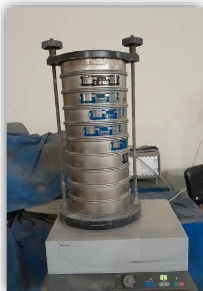
Figure III.14 Série de tamis et tamiseuse électrique.
