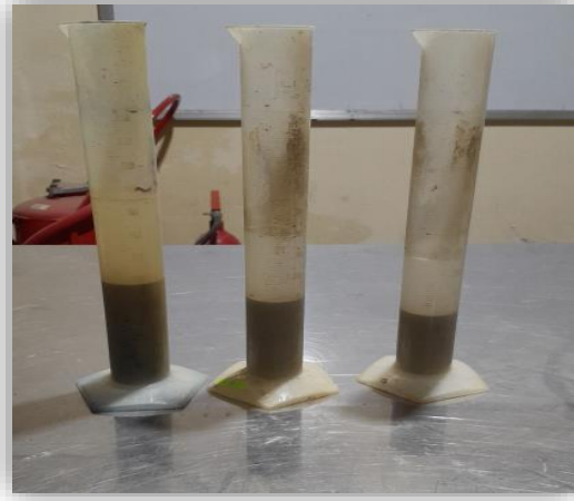
Figure III.12 Essai de la masse volumique absolue
