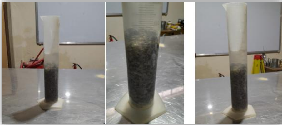
Figure III.17 Essai de la masse volumique absolue
