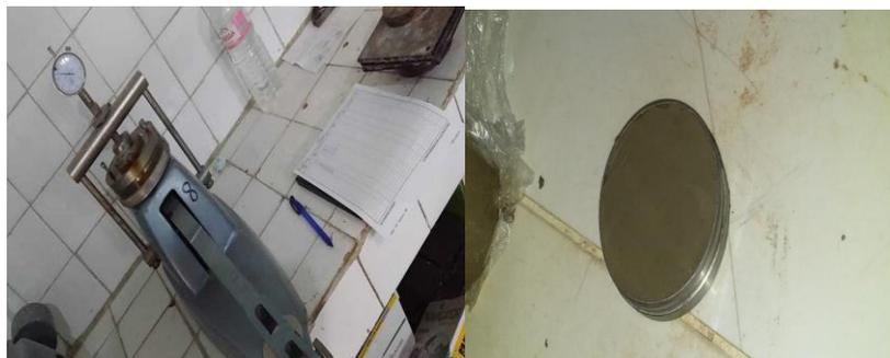
Figure III. 29 : Photos de l'oedomètre
