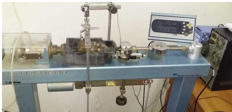
**Figure III. 14** : Appareille de cisaillement
