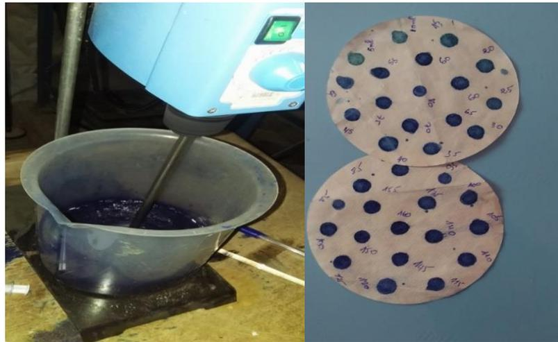
**Figure III. 4:** Essai au bleu de méthylène
