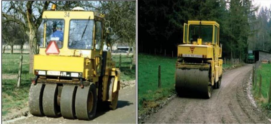
**Figure II. 20:** Compactage aux compacteurs à pneus et cylindrique
