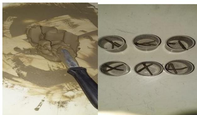
**Figure III. 3 :** Détermination de la limite de plasticité
