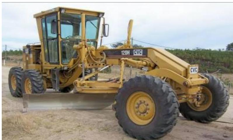
**Figure II. 21:** Réglage d'une couche compactée avec niveleuse
