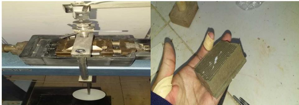
**Figure III. 17 :** Cisaillement des éprouvettes dans la boîte de Casagrande
