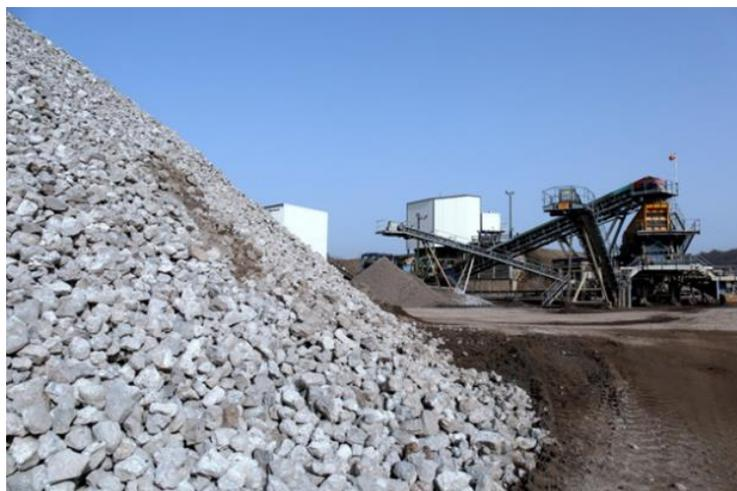
**Figure II. 6 :** Agrégat de laitier de haut fourneau
