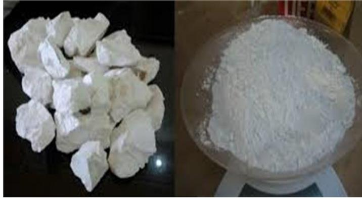
**Figure II. 2:** Transformation du calcaire en chaux vive
