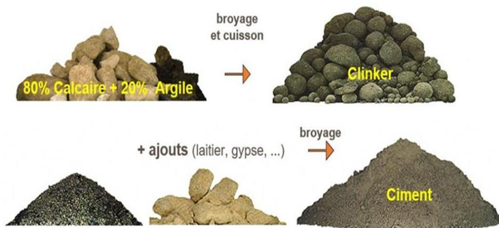
**Figure II. 4:** Les grandes étapes de la fabrication du ciment
