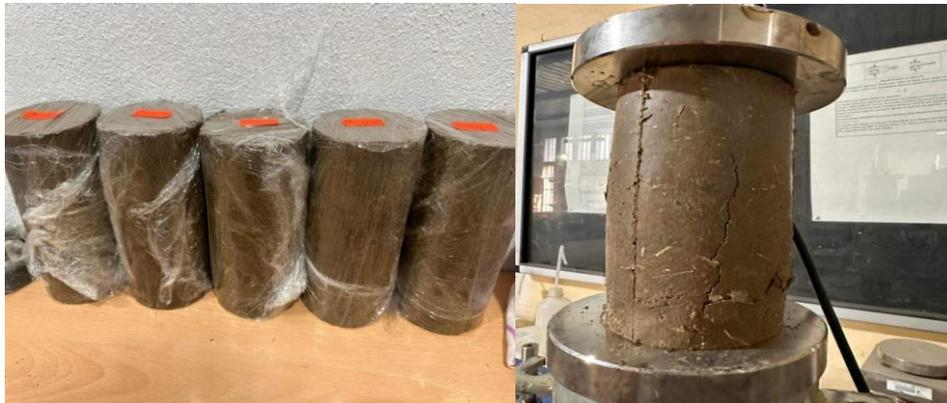
**Figure III. 12** : Photos des éprouvettes durant la cure et au cours d'essai
