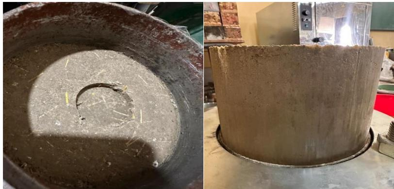
Figure III. 7 : Poinçonnement du sol
