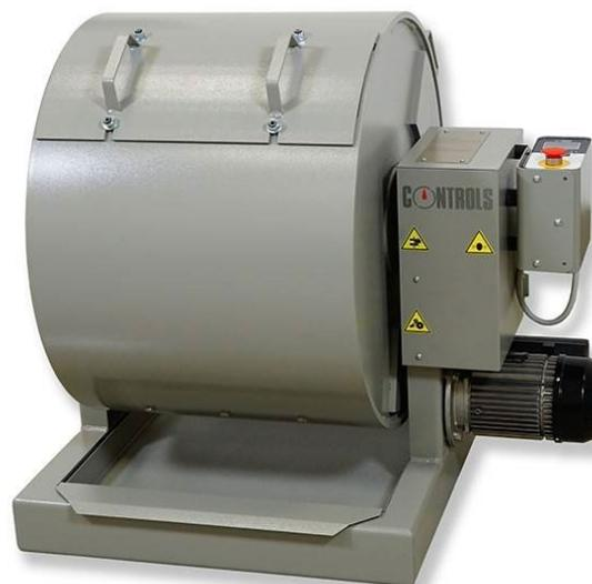
Figure III.8 : L'essai los Angeles
