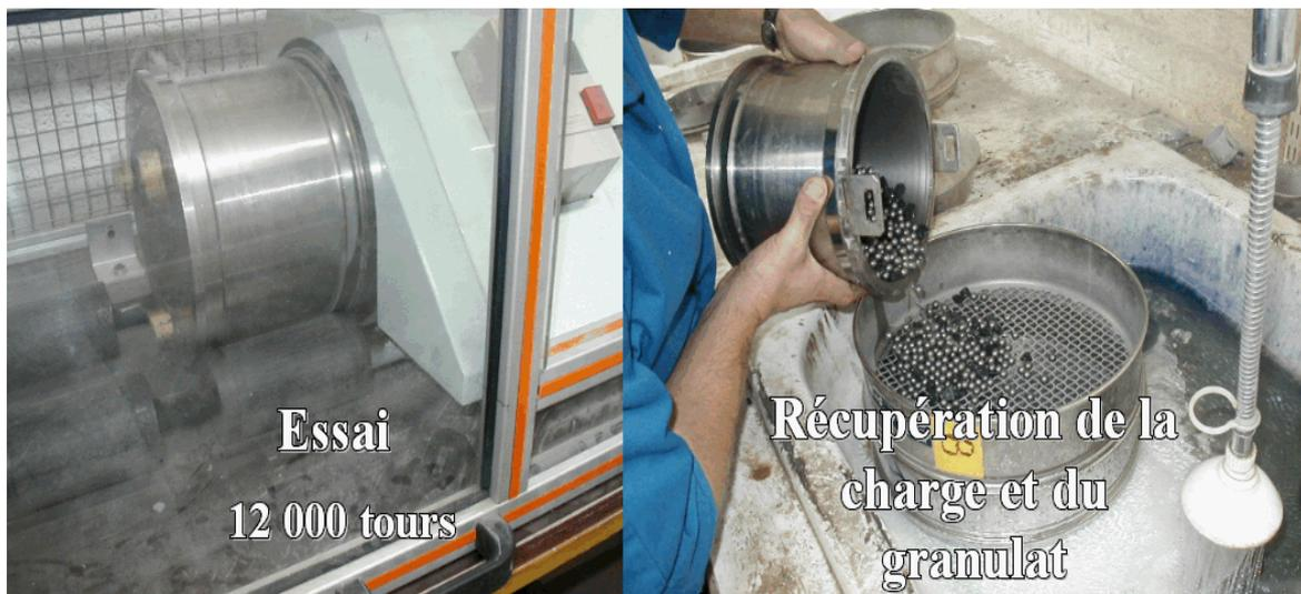
Figure III.9 : Essai Micro Derval
