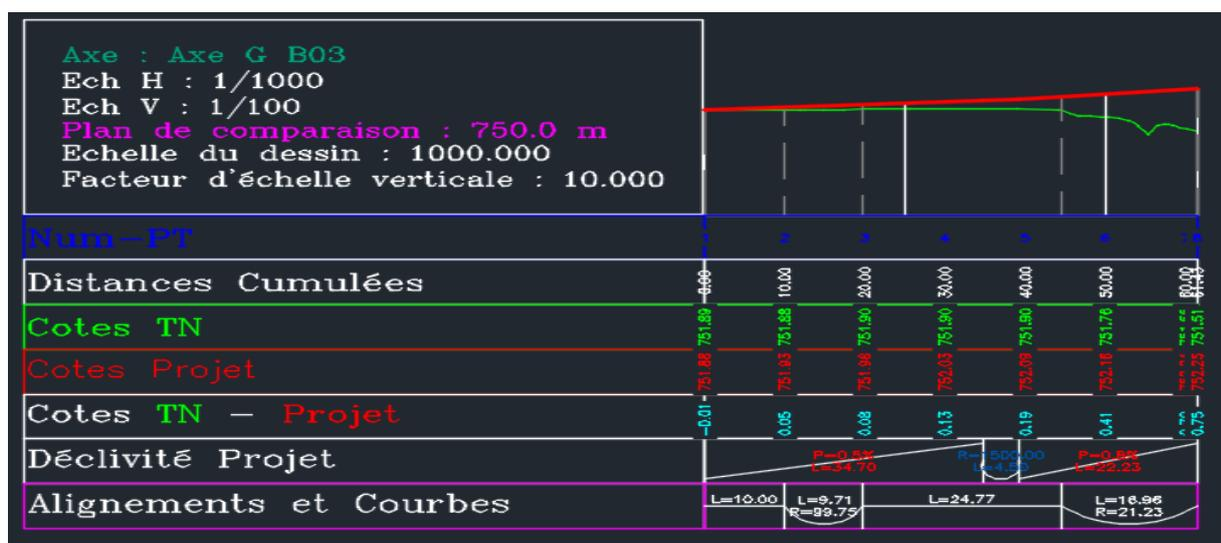
Figure II.32 : Profil en long (Axe G B03)
