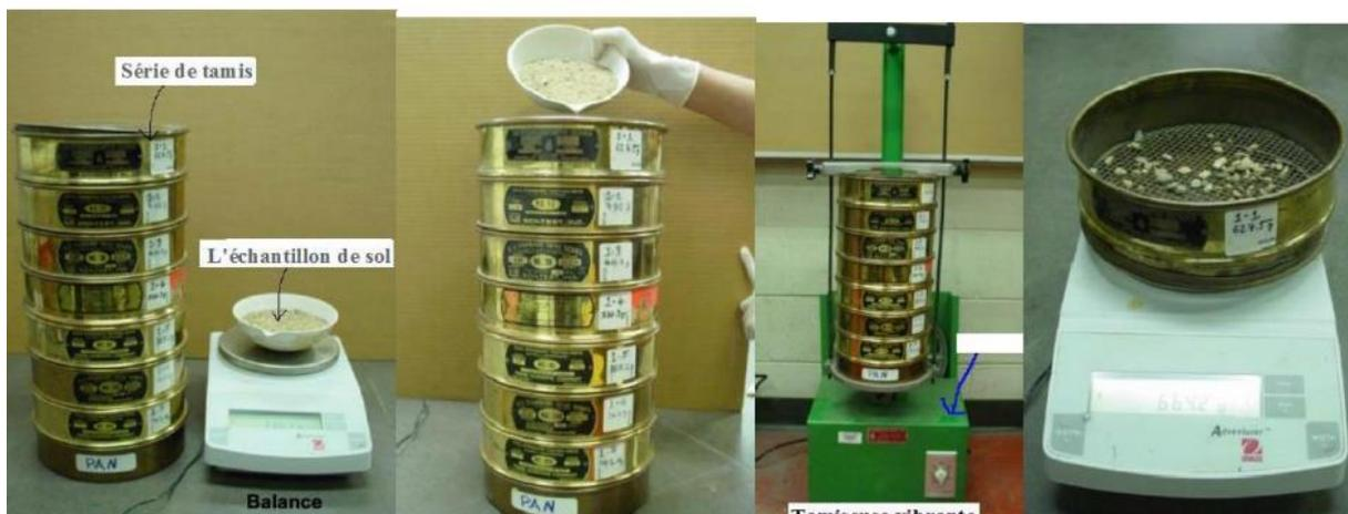
**Figure III.12.** L'analyse granulométrique par tamisage. Mettre une autre photos
