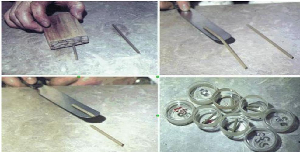
Figure III.18. Détermination de la limite de plasticité.
