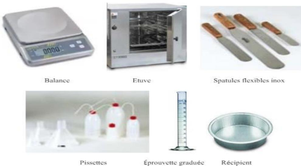
Figure III.11. Equipements utilisés pour l'essai de teneur en eau.
