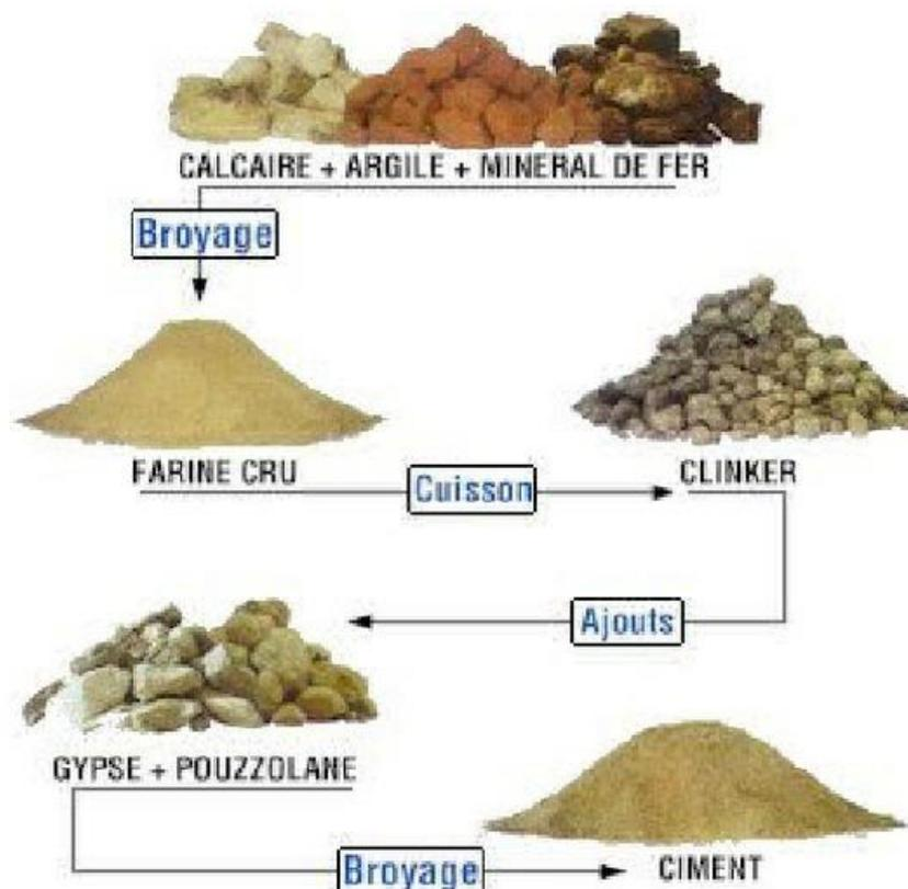
**Figure II.12.** Processus de fabrication de ciment.
