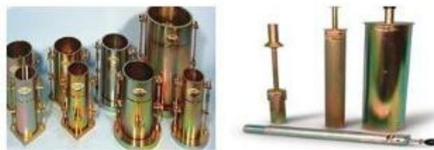
**Figure III.19.** Matériels de l'Essai Proctor.
