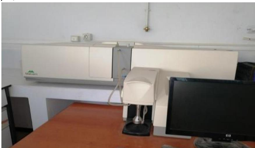
**Figure III.9.** Appareil d'analyse granulométrique. Mastersizer 2000 Malvern.
