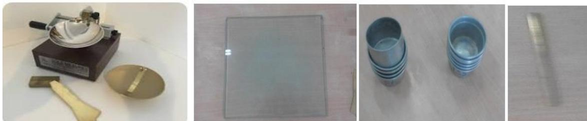
Figure III.16. Appareillage nécessaire pour déterminer  $\omega_L$ .
