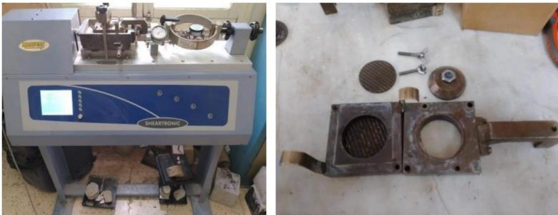
**Figure III.25.** Essai de cisaillement rectiligne à la boîte avec les instruments de mesure.
