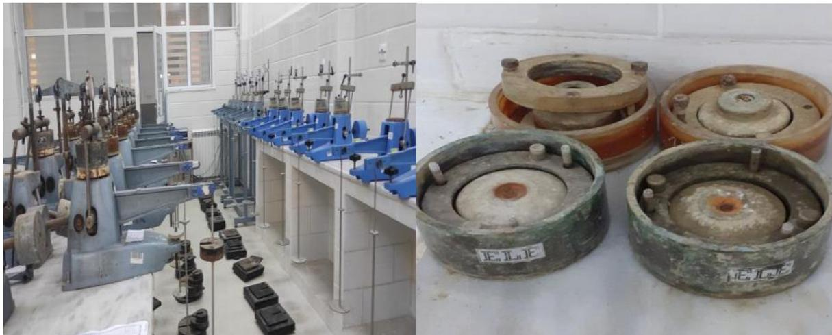
**Figure III.29.** Appareillage de l’essai Oedométrique.
