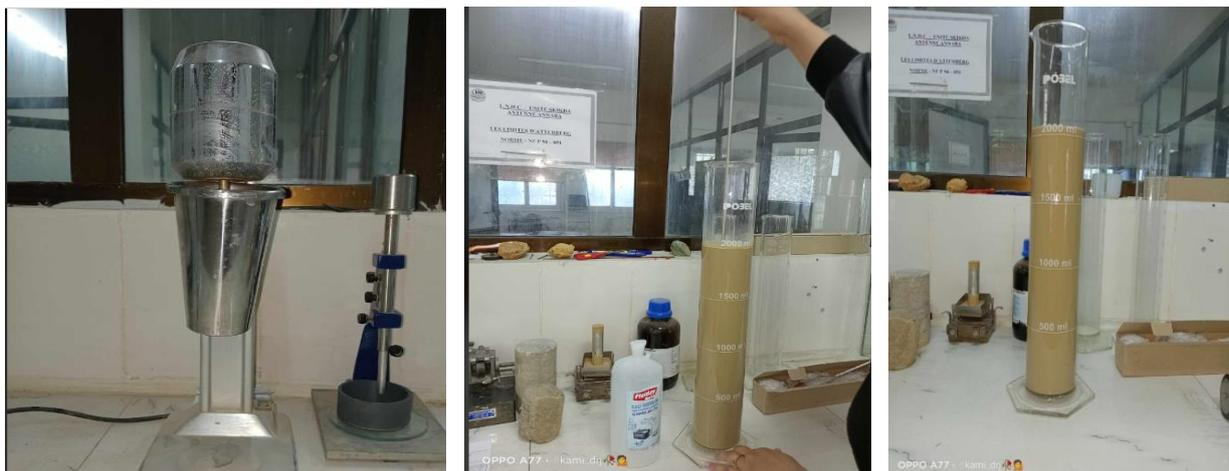
**Figure III.13.** L'analyse granulométrique par sédimentométrie.
