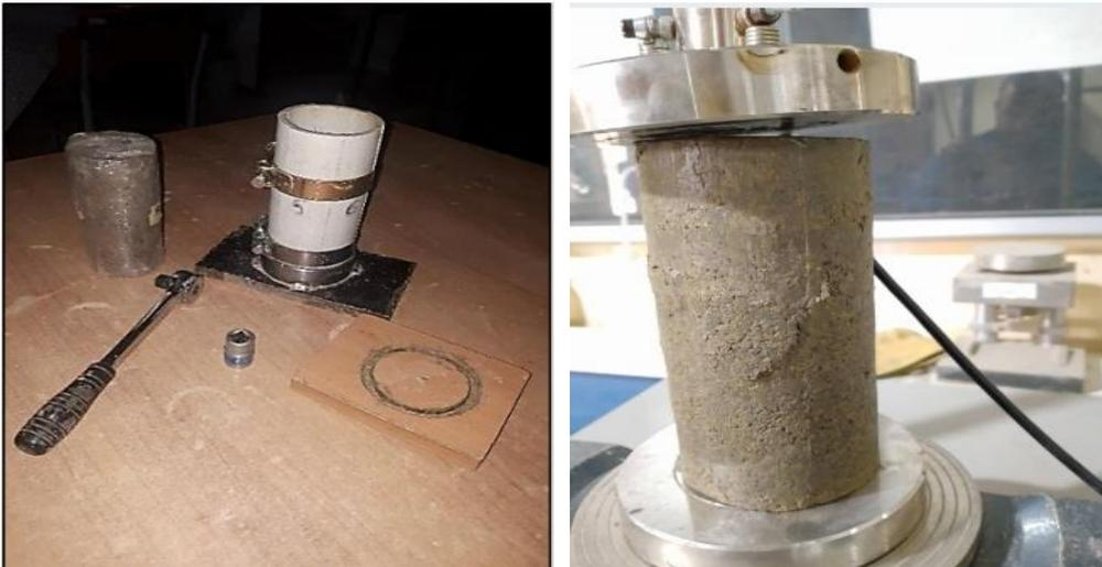
**Figure. III.24.** Appareil de compression au niveau de laboratoire de recherche (université 8 Mai 1945 Guelma)
