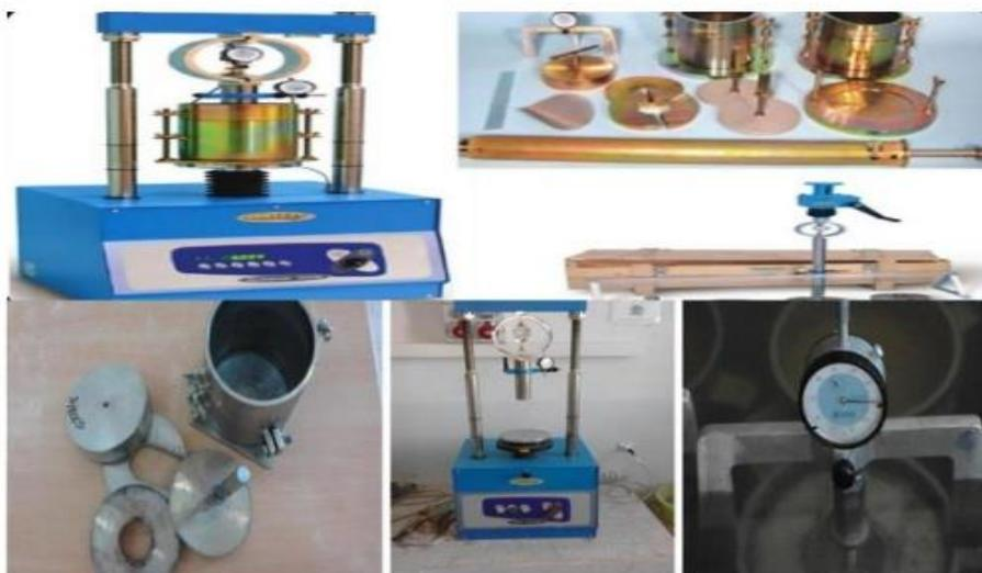
Figure III.22. L’essai CBR (California Bearing Ratio).
