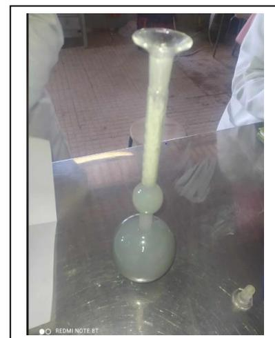
**Figure III.8.** Essai de la masse volumique absolue.
