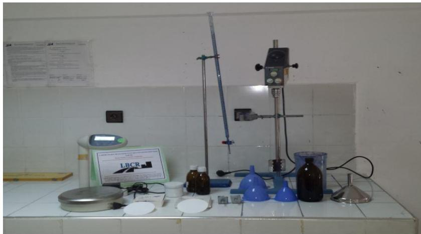
Figure III.6. Equipements utilisés pour l'essai pour l'essai au bleu de méthylène.
