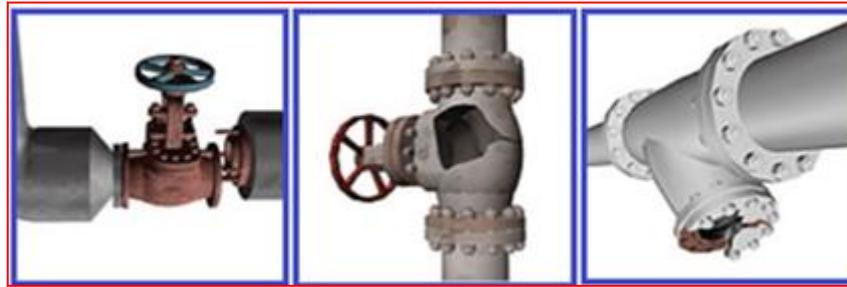
Figure 3.9 : Quelques exemples de conduites endommagées par des coups de bélier
