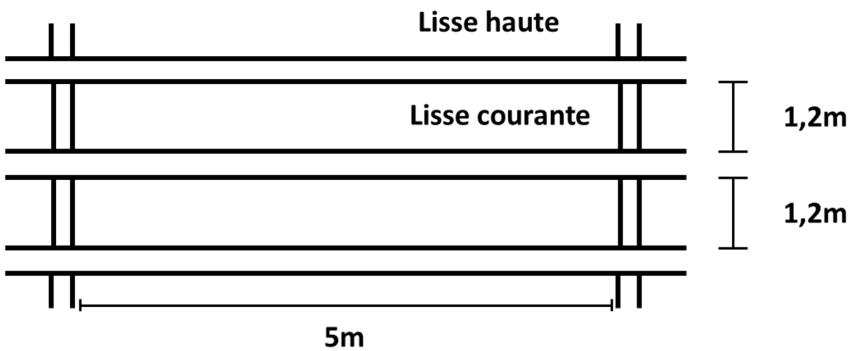
Figure III.7 : Disposition des pannes au pignon bloc 2
