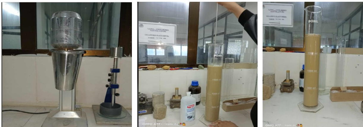
Figure III.14 L'analyse granulométrique par sédimentométrie.
