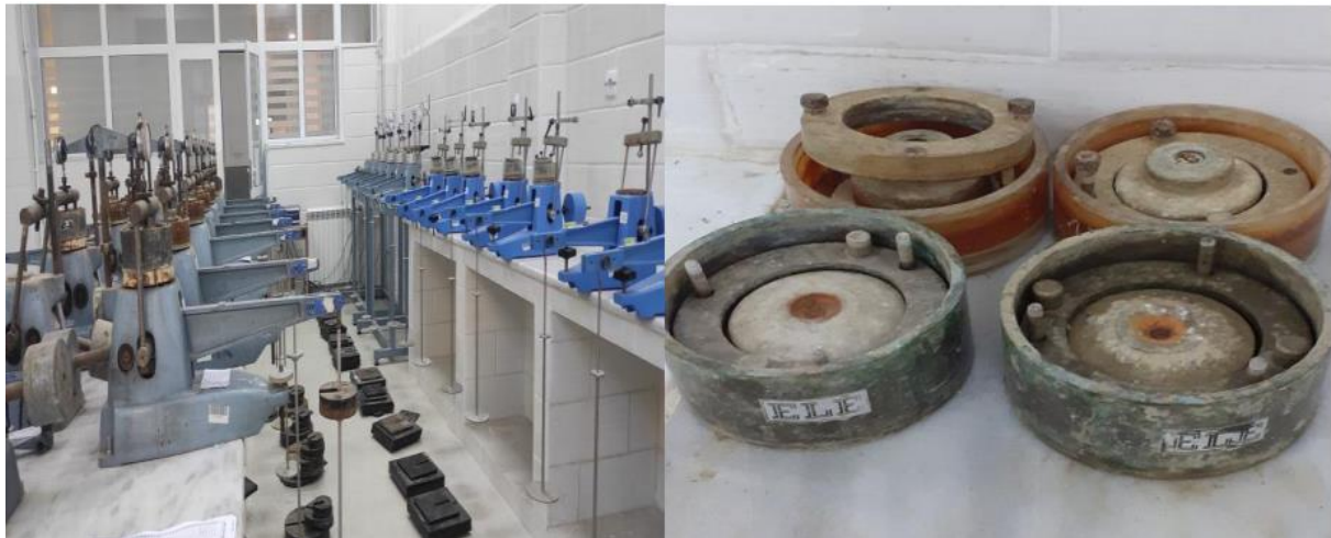
Figure III.32. Appareillage de l'essai Oedométrique.
