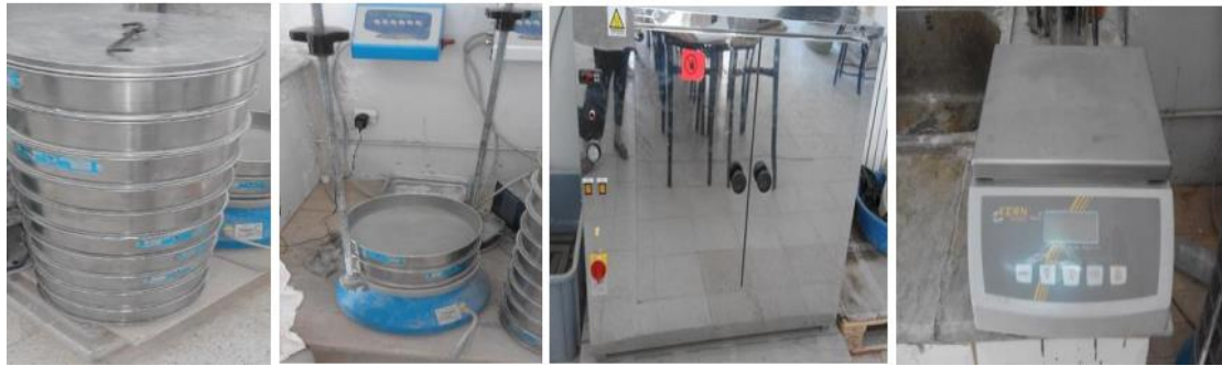
Figure III.13. L'analyse granulométrique par tamisage.
