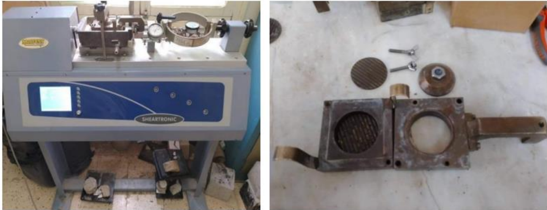
Figure III.28. Essai de cisaillement rectiligne à la boîte avec les instruments de mesure.
