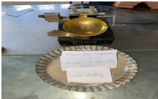
Figure III.17. Appareil de Casagrande.
