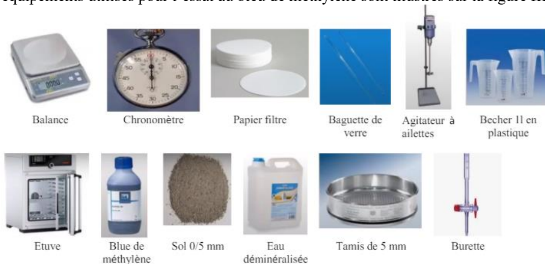
Figure III.6. Les équipements utilisés pour l'essai au bleu de méthylène.
