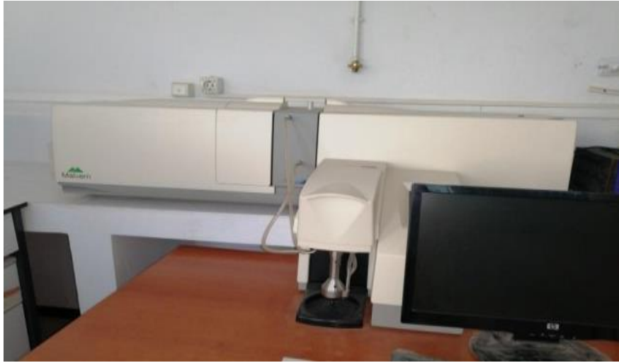
Figure III.10. Appareil d'analyse granulométrique. Mastersizer 2000 Malvern.
