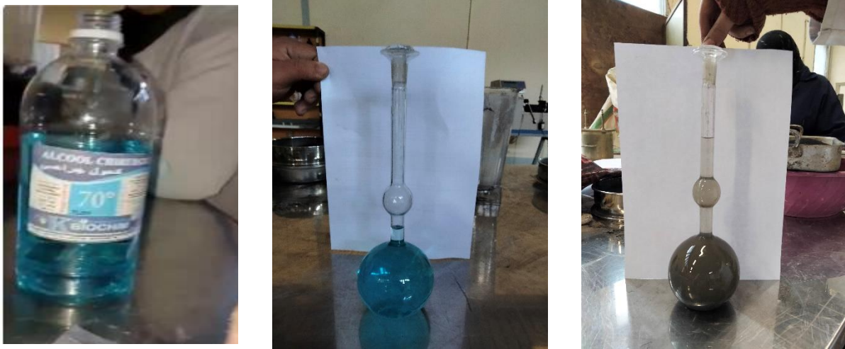
Figure III.9. Essai de la masse volumique absolue.
