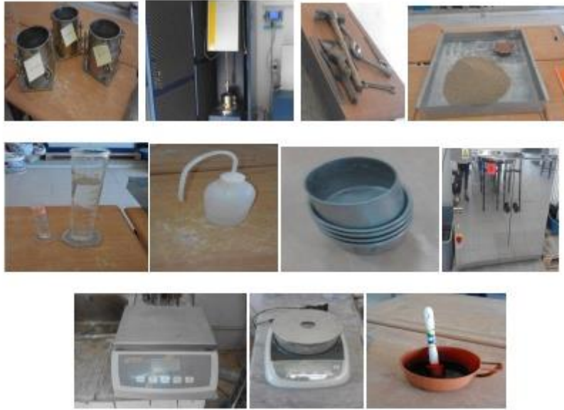
Figure III.22. Matériels de l'essai Proctor.
