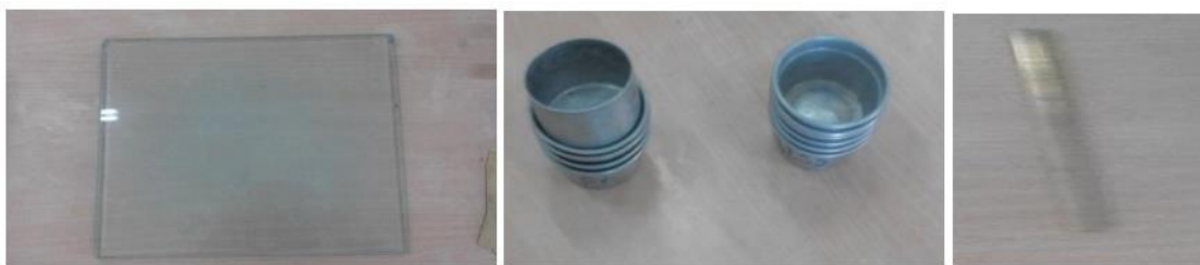
Figure III.20. Appareillage nécessaire pour déterminer W_p .
