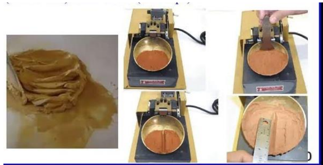
Figure III.18. Mode opératoire pour \omega_L (Casagrande).
