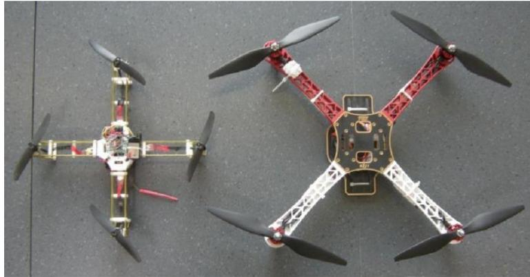
**Figure II.2** : Les deux types de quad-copter [1]
