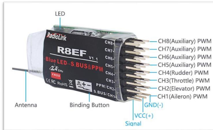
Figure III .9 : Récepteur R8EF. [2]
