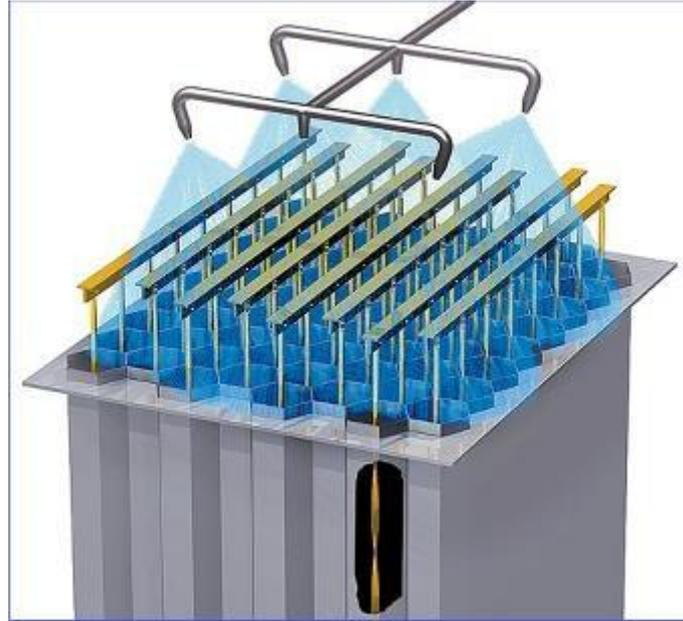
**Figure I.3 :** Schéma simplifié d'un précipitateur électrostatique humide. [14]
