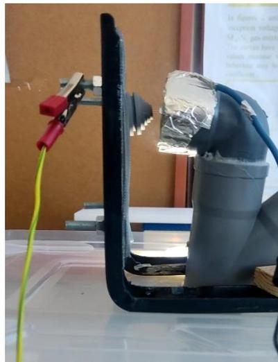
**Figure III.3 :** le support de l'aiguille.
