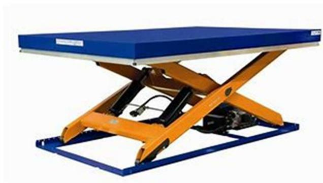
Figure 2.3- Table élévatrice à ciseau simple.
