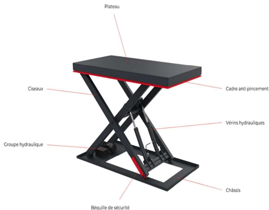
Figure 2.10 - Eléments composants de la table élévatrice.
