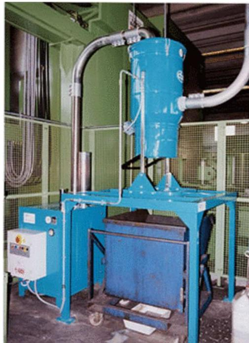
**Figure 1.9** - Système de levage par aspiration
