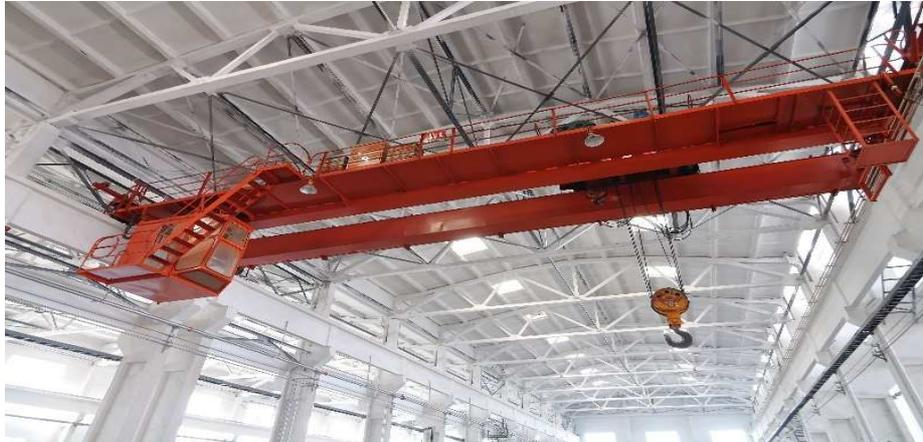
**Figure 1.10** - Pont roulant
