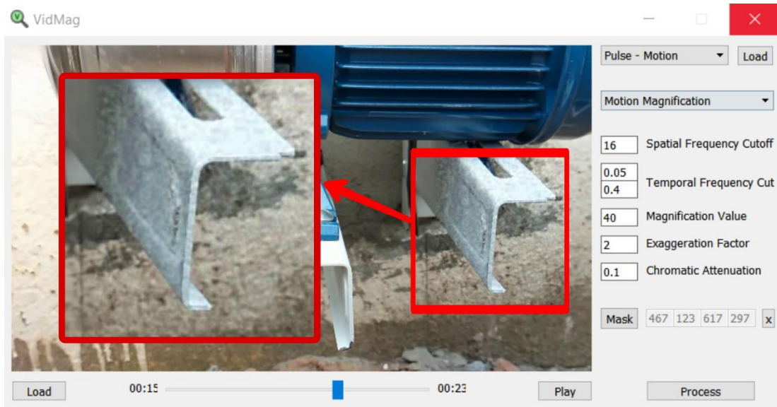
Figure IV.2. Détection des parties vibrants sur une pompe à eau : Vidéo originale et résultat après traitement. Le bras à droite de l'image est détecté comme la source de vibrations
