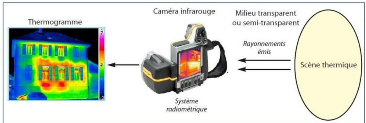
Figure II.7 Principe de fonctionnement de la caméra infrarouge. [44]
