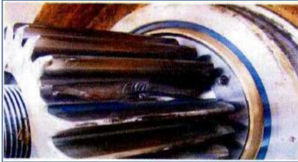
Figure.I.16 Défaits réels d'engrenage localisé [38]
