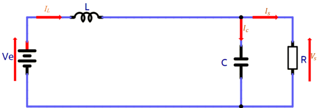
Figure 2-8 : Circuit équivalent du Boost quand l'interrupteur est ouvert
