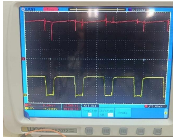
Figure 3.10 : Signal de commande et tension de sortie pour D=75\%
