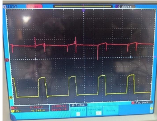
Figure 3-8 : Signal de commande et tension de sortie pour D=25\%
