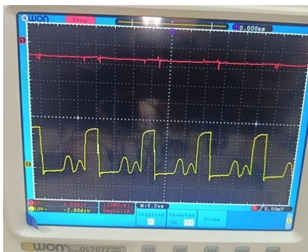
Figure 3-15 : Signal de commande et tension de sortie pour D=25\%
