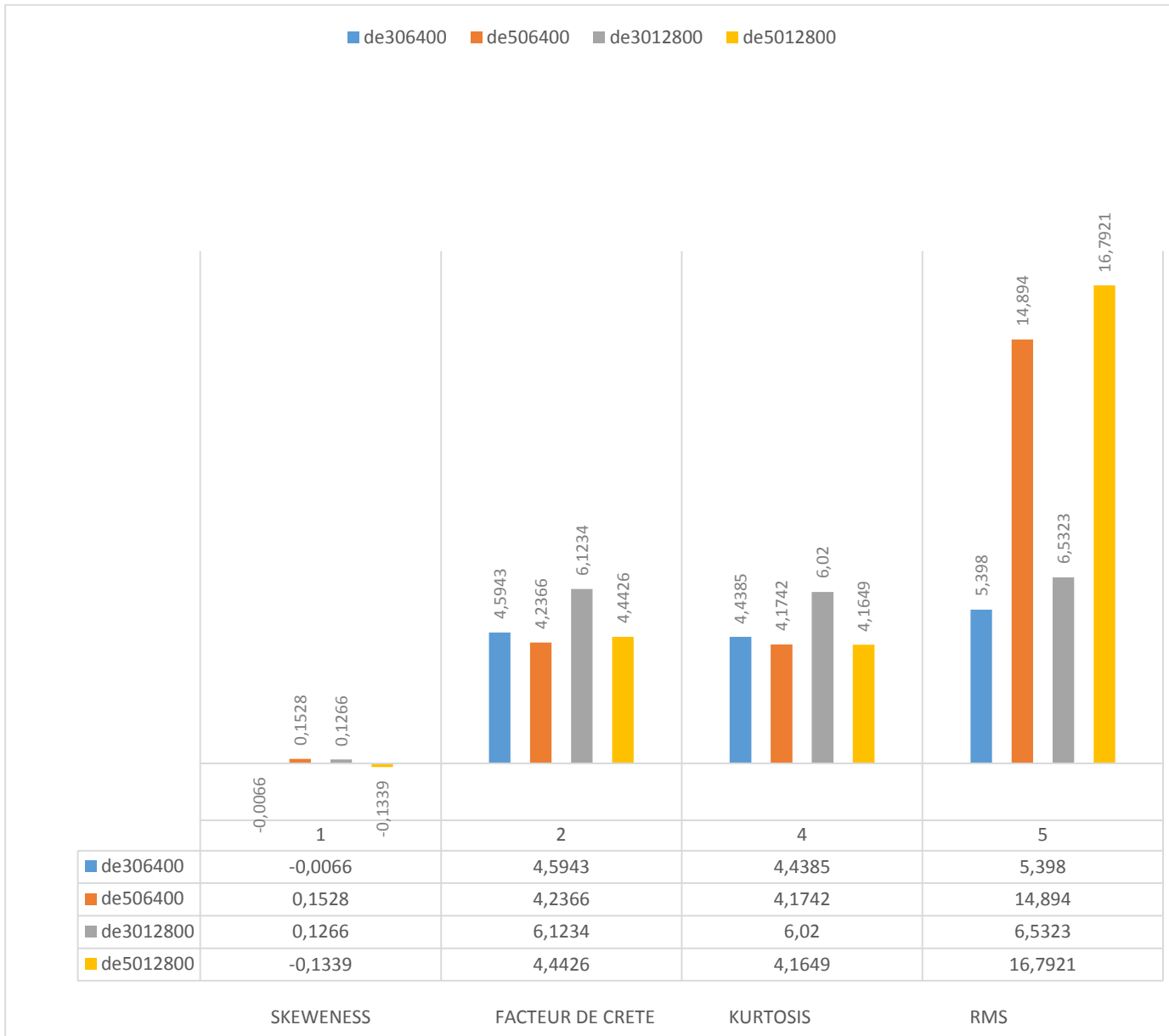
Figure 2.13 : Analyse statistique d'un défaut double sur la bague extérieure
