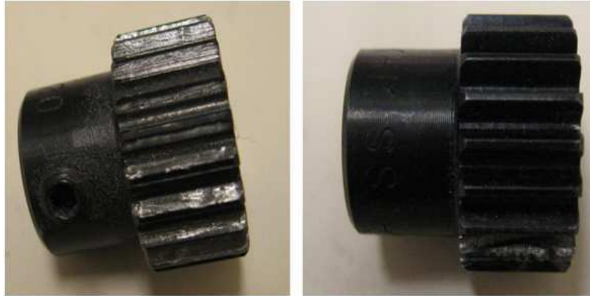
Figure 1.7 : Un défaut d'engrenage (à gauche : l'usure de toutes les dents ; à droite: fragment d'une dent) [11]
