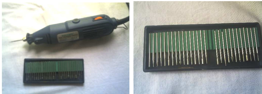
Figure 2.1 : Matériel utilisé pour la simulation des défauts
