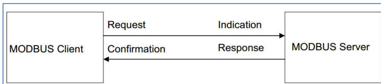
FIGURE 2. 16 : MODBUS CLIENT/SERVER COMMUNICATION MODEL
