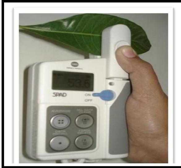
Figure 5. Chlorophylle mètre SPAD 502 de Minolta ([www.adc.co.uk](http://www.adc.co.uk) ).
