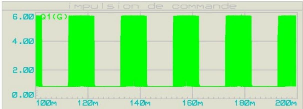
Figure III.4: Allure de l'impulsion de commande du transistor MOSFET Q1.
