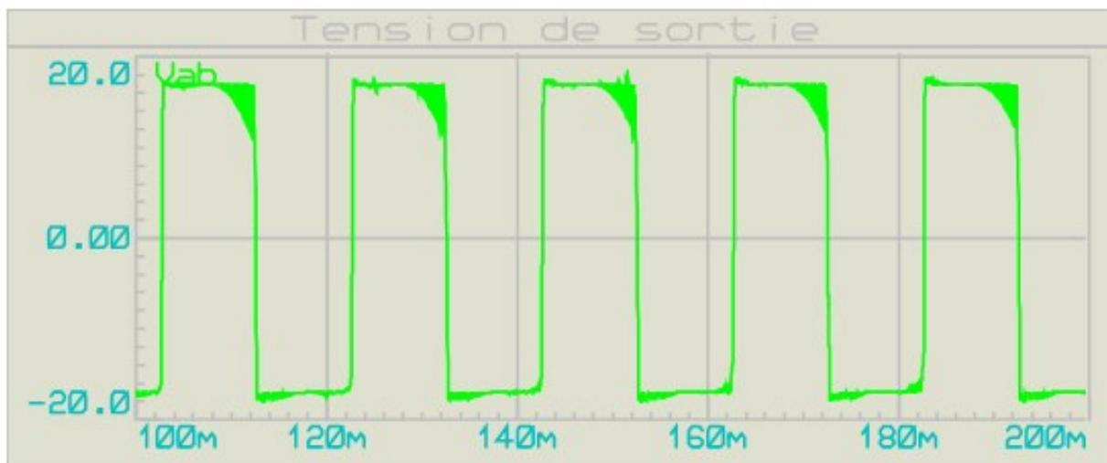
Figure III.6: Allure de la tension  $V_s$  à la sortie du transformateur élévateur.
