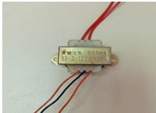
Figure.III.10: Transformateur 12-0-12V.
