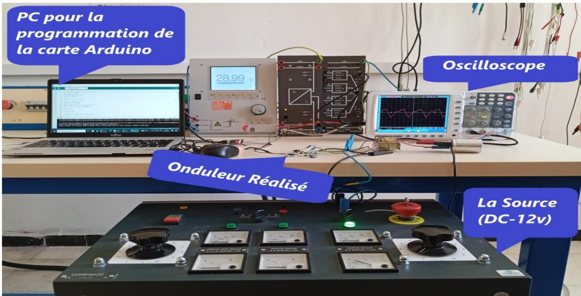
Figure.III.18: Banc d'essai expérimental.
