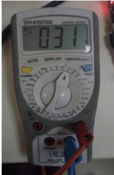
Figure.III.22: La valeur de la tension mesurée à la sortie l'onduleur.
