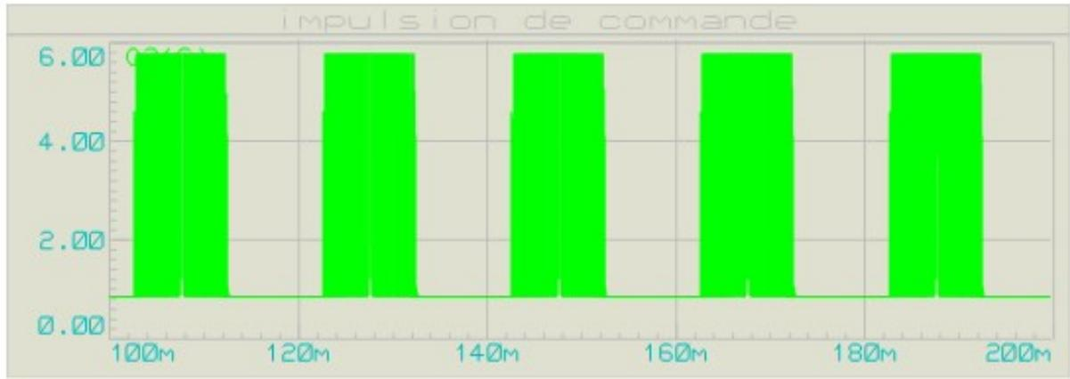
Figure III.5: Allure de l'impulsion de commande du transistor MOSFET Q2.
