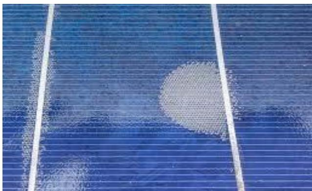
Figure 31 : Défaut de délaminage.
