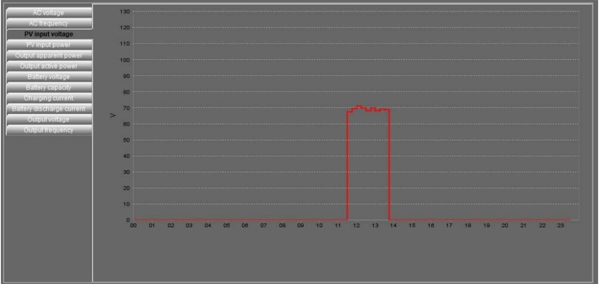
Figure 79 : Tension d'entrée de l'installation PV
