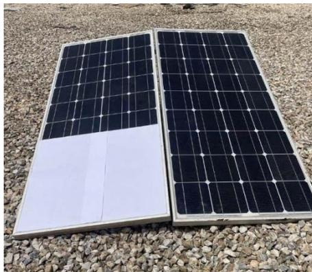
**Figure 58 :** Représentation de l'ombrage au deuxième essai.
