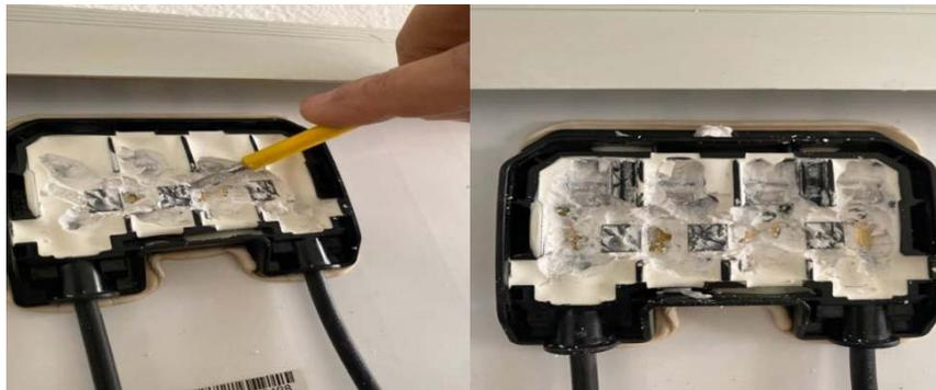
Figure 48 : L'ajout de diode pour la protection contre le court-circuit
