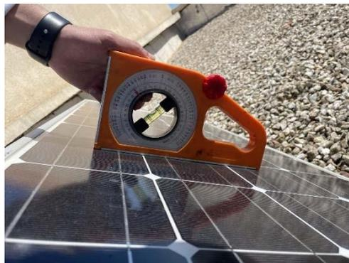
**Figure 28** : Représentation d'une mesure d'un angle sur un panneau PV
