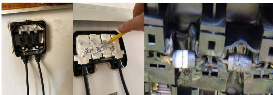
**Figure 34:** Exemple de défauts de diode by-pass
