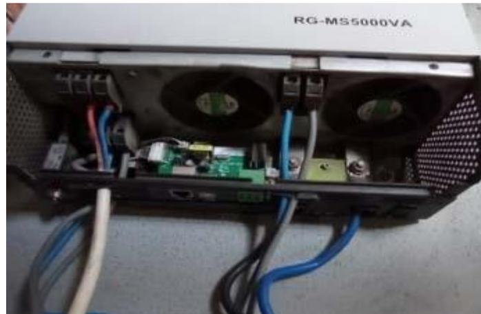
**Figure 73 :** Onduleur hybride utilisé.
