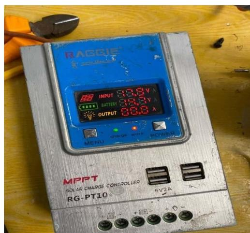
Figure 46 : Affichage input Affichage batterie 14.7v=charge off
