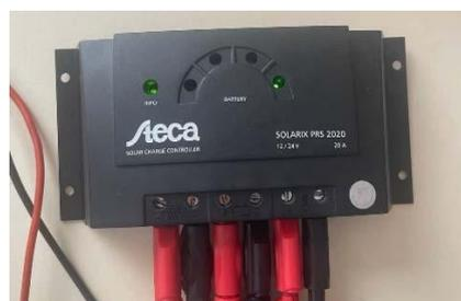
**Figure 91** : Le régulateur utilisé
