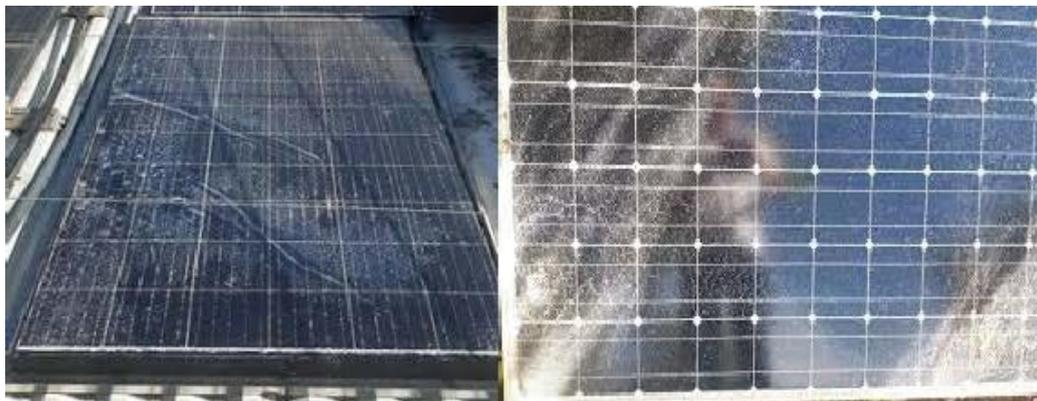
**Figure 30** : Fissures dans les cellules PV
